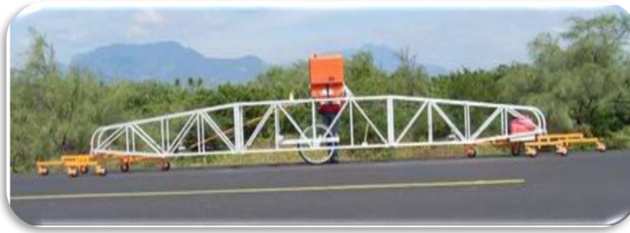
Ilustración 16: Perfilografo Longitudinal de California (SCT, Guía de procedimientos y técnicas para la conservación de carreteras en México, 2014)
