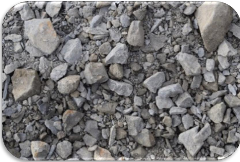
Ilustración 10: Material de Sub-Base (MMG, 2019)
