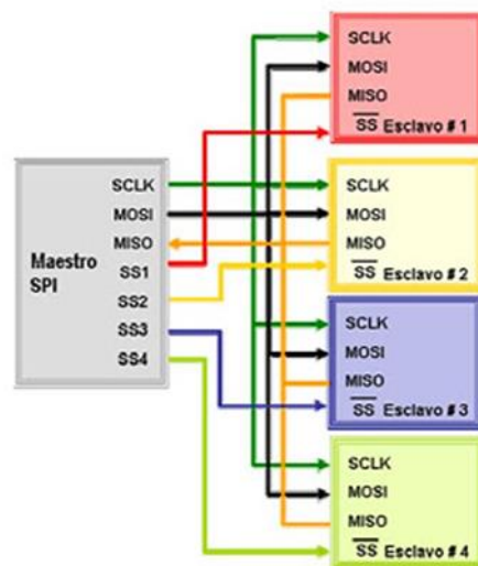
Figura 4.9 Conexión de varios dispositivos por SPI.
