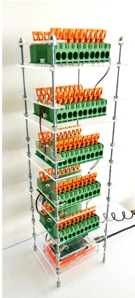
Figura 3.8 Sistema de instrumentación para una cámara de termovació.
