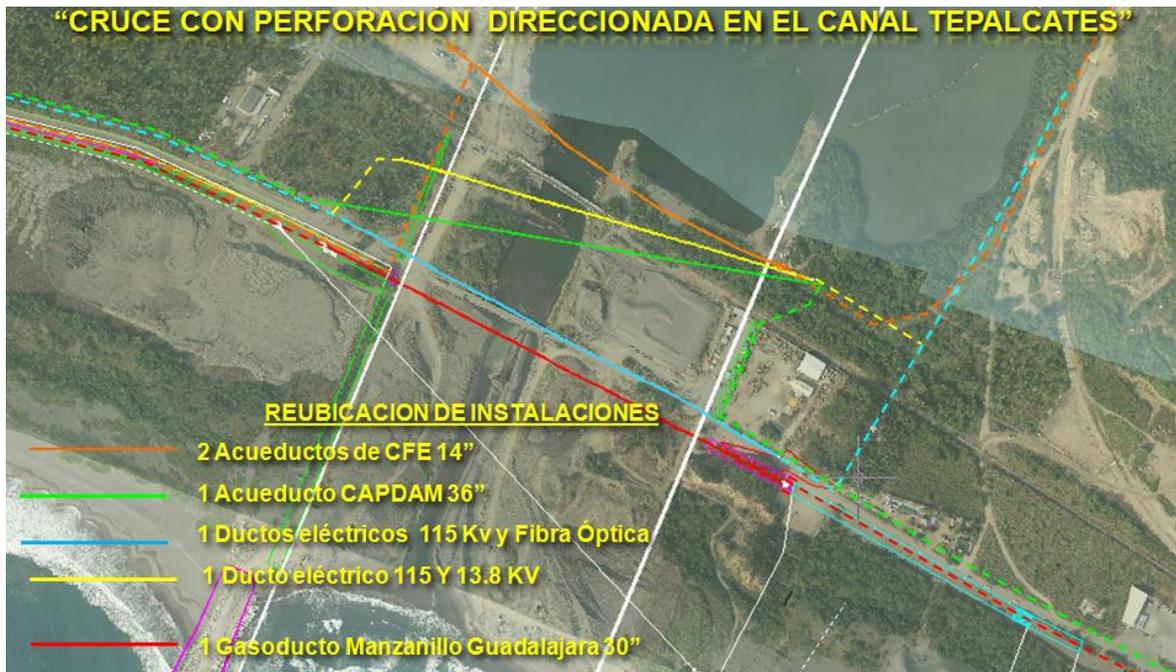
Imagen 12. Detalle de Trayectorias de los Cruces direccionados
