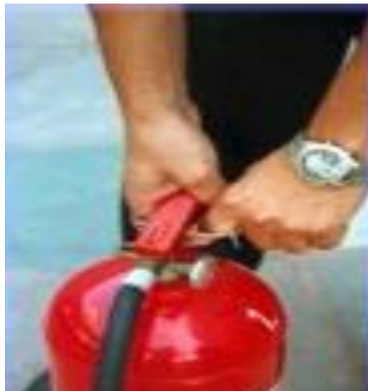
Figura 9. Uso de extintor, como quitar el anillo de seguridad.
