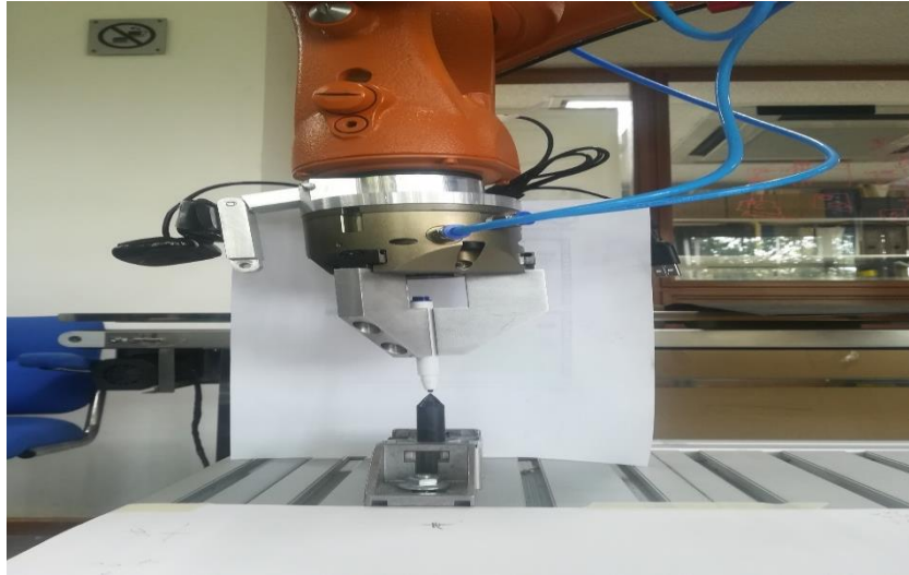
Ilustración 53 Herramienta patrón para calibración de herramental del KUKA.
