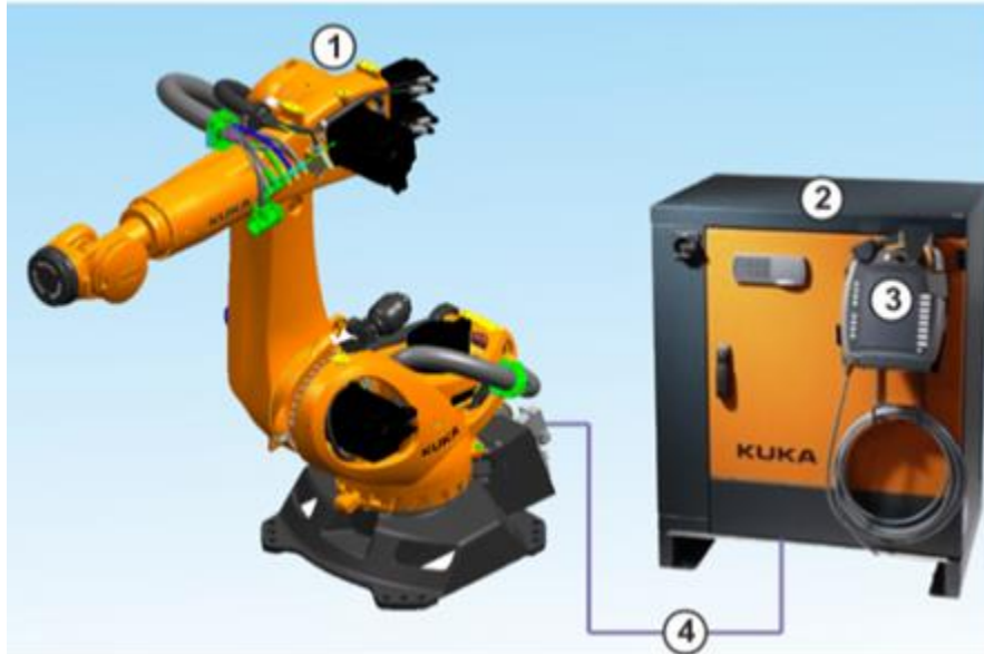
Ilustración 36 Elementos que componen a un robot KUKA Industrial. Ver referencia [39].
