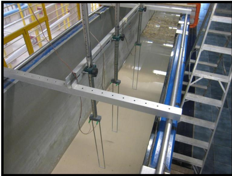
*Figura IV-4 Colocación de los sensores de nivel.*
