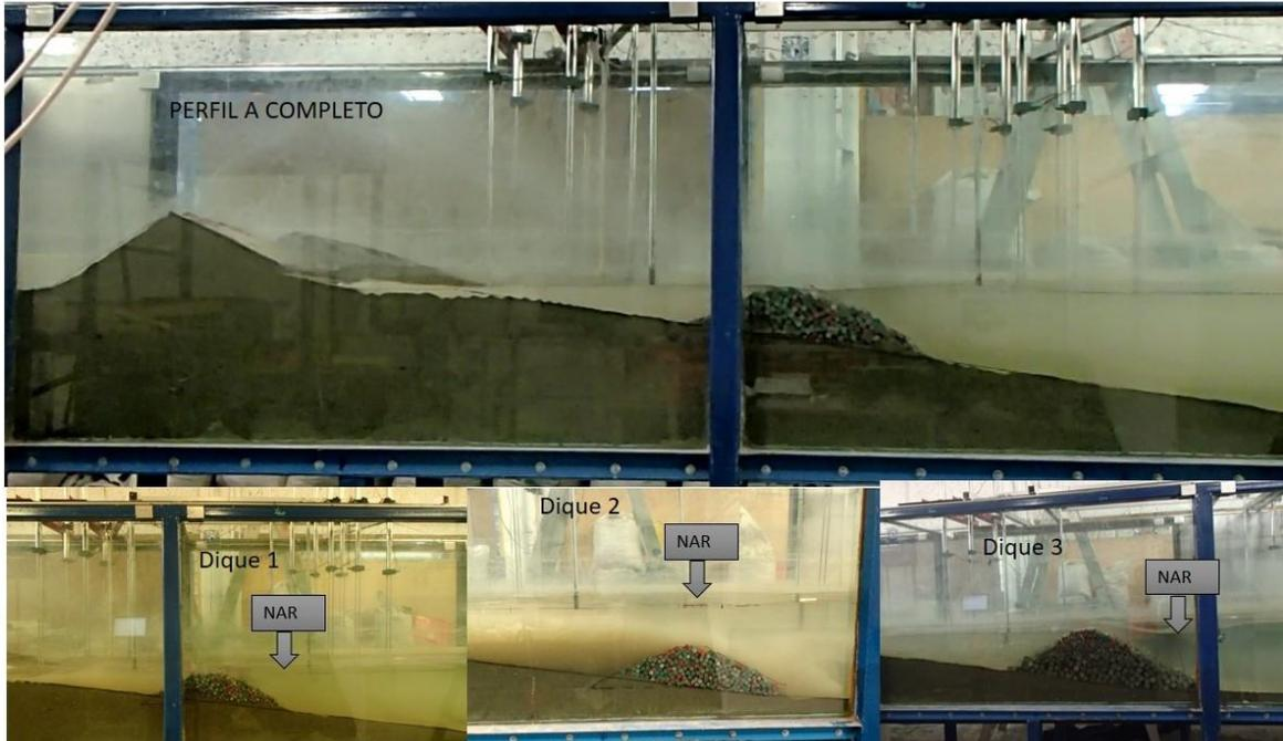
Figura IV-3 Perfil de playa A mostrando los tres diques usados (NAR=Nivel de agua en reposo).
