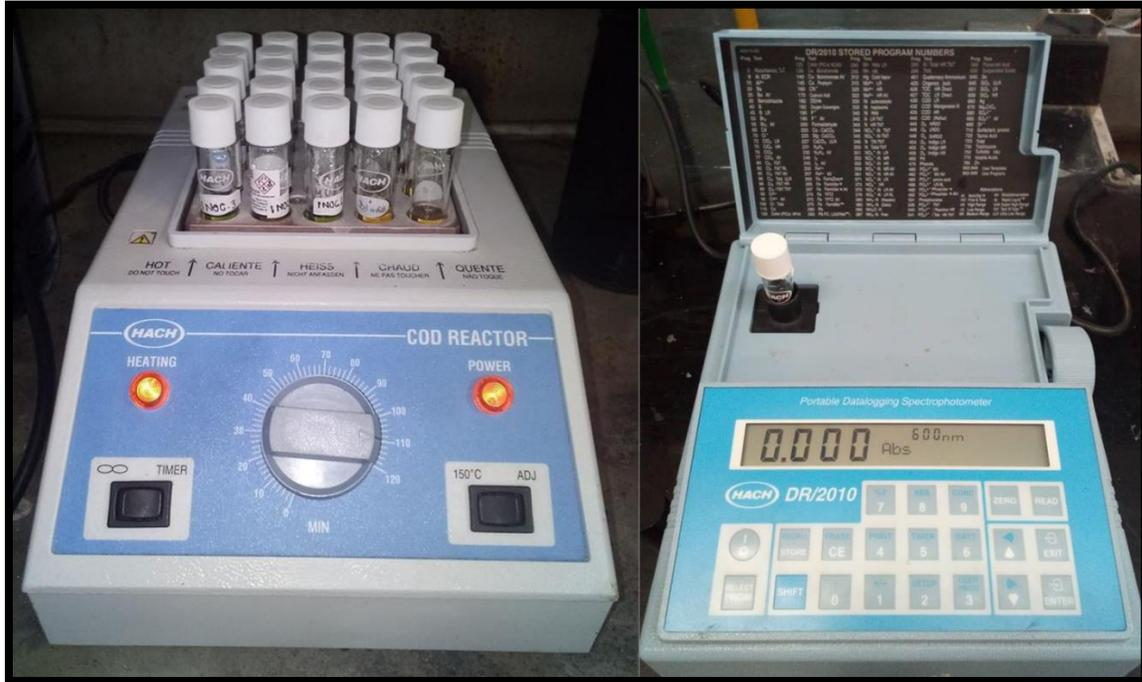
Equipo utilizado para la determinación de DQO
