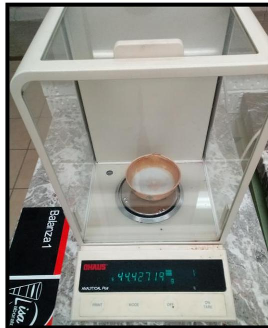
*Balanza analítica para determinaciones gravimétricas realizadas*
