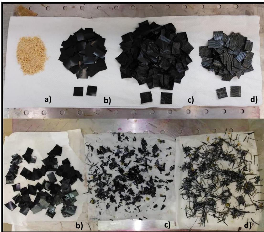
*Figura 4. 5. Antes (foto superior) y después (foto inferior) del material de prueba luego del proceso de biodegradación: a) celulosa o aserrín (S1), b) agrolástico convencional (S2), c) agrolástico biodegradable proveedor 1 (S3) y d) agrolástico biodegradable proveedor 2 (S4)*
