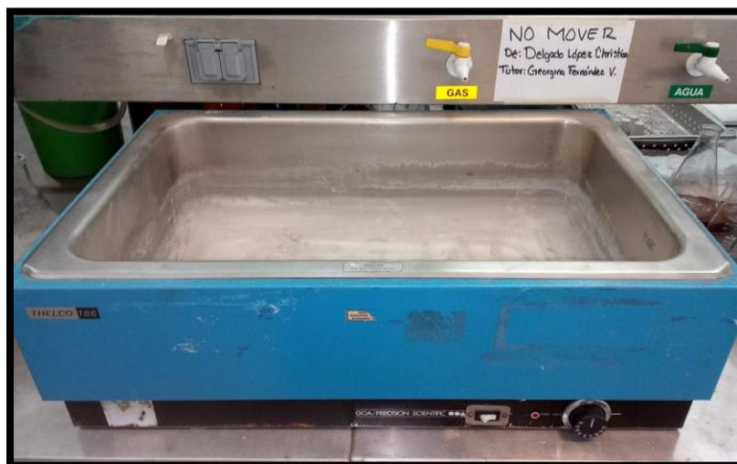
Figura 3. 17. Baño María donde se instalaron los reactores para las pruebas de biodegradación de muestras agrolásticas.
