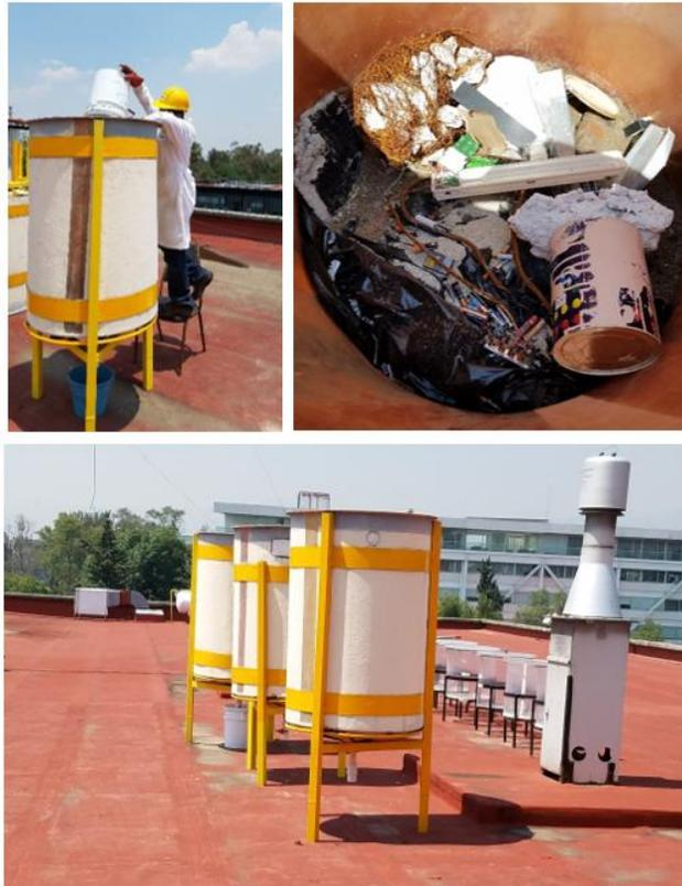
**Fig. 4.6 Vertido de subproductos en lisímetros**
