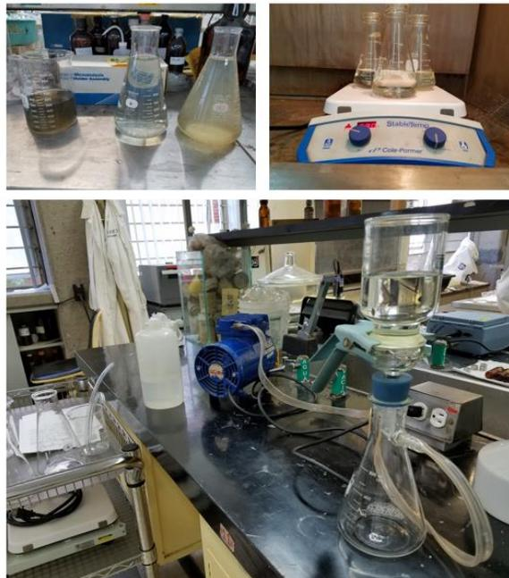
**Fig. 4.10 Preservación de lixiviado para componentes inorgánicos y metales**
