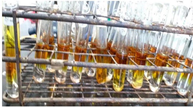
Figura 5.9. Preparación de tubos de digestión
