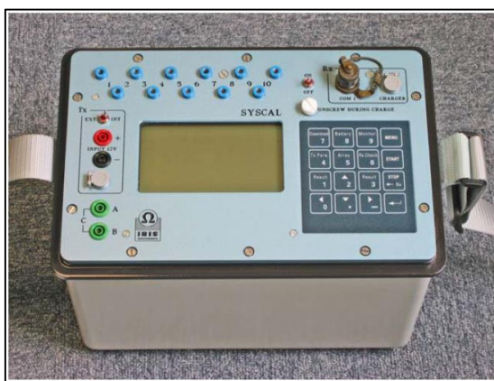
Figura 23 Consola SYSCAL Pro utilizada en nuestro levantamiento ( IRIS Instruments, 2016)
