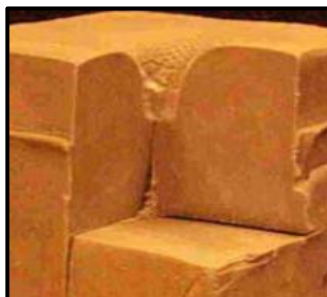
Figura 2.7 Penetración del proyectil (trauma) en material testigo. Ilustración, Advanced Body Armor Utilizing Shear Thickening Fluids (STF) (p.8), 23rd Army Science Conference, Orlando, FL (2002).
