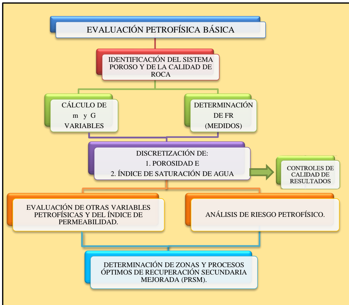
Figura 7.1 Módulos que conforman el proceso de caracterización petrofísica avanzada de la Tecnología IFV® (Mendoza-Romero, et al., 2011).
