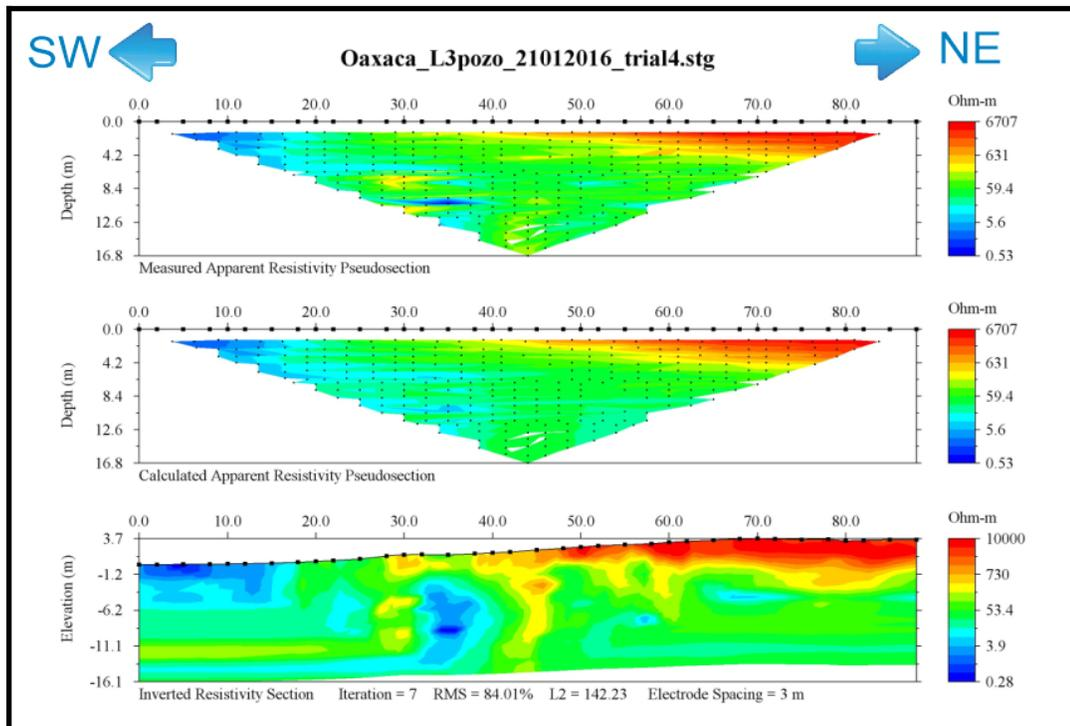
Figura Anexo 3.15. Sección sin filtro con máxima resistividad de 10,000 [ohm•m] del perfil cercano al pozo en Oaxaca.
