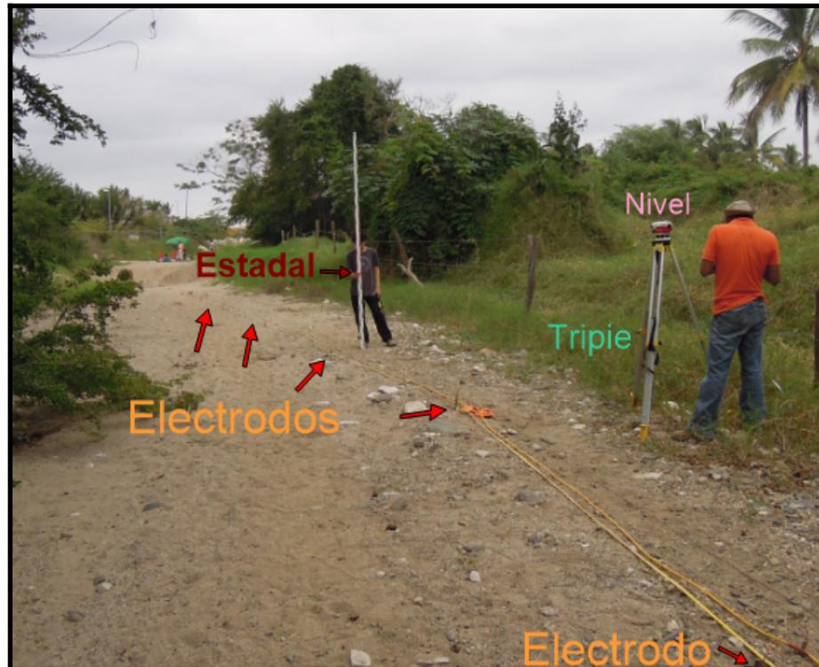
Figura 4.1.3. Levantamiento topográfico de los puntos donde se encuentran los electrodos.
