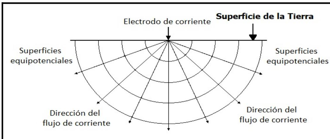
Figura 2.2.2. Representación de la distribución del potencial y la dirección del flujo de corriente cuando se tiene una fuente puntual (modificada de Loke, 2004).
