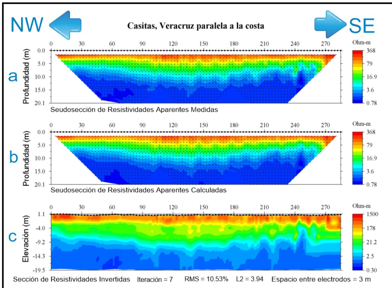
Figura 4.2.3. Resultado del perfil 2 realizado en el sitio de Casitas, paralelo a la costa con inversión robusta.
