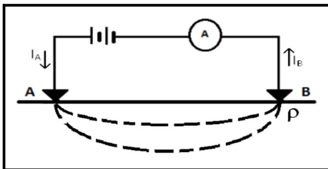
*Figura 2.1. Esquema que representa la intensidad de corriente aplicada en el terreno.*
