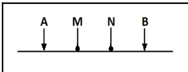
Figura 2.2.1. Esquema representativo de un arreglo de 4 electrodos para la medición de resistividad.
