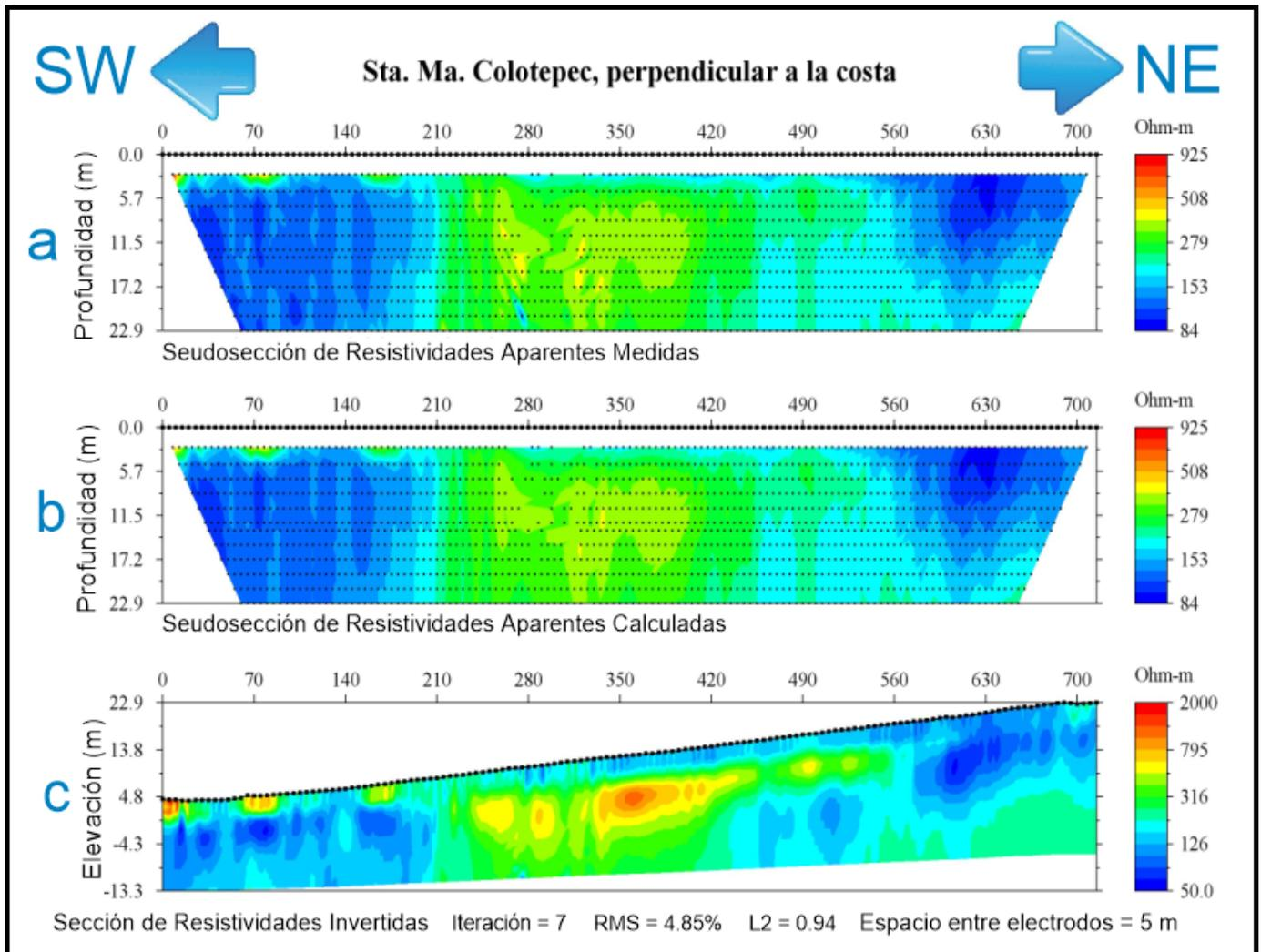
Fig 4.4.2. Resultado del perfil de Oaxaca, perpendicular a la línea de costa, empleando una inversión robusta.
