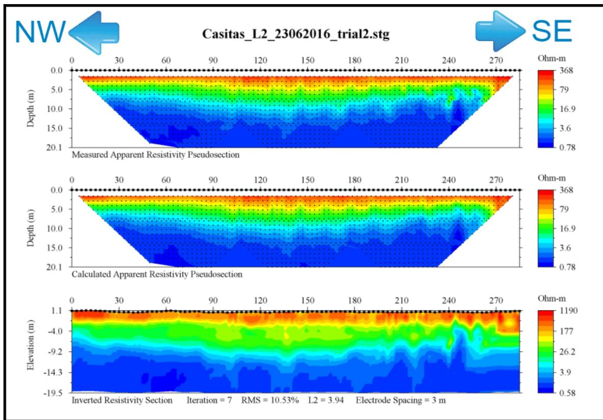
Figura Anexo 3.4. Sección original, sin cambiar escala de resistividades de Casitas paralela a la costa, utilizando una inversión robusta.
