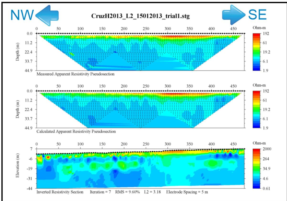
Figura Anexo 3.8. Resultado de la inversión robusta del perfil perpendicular a la línea de costa en la zona de Litibú, sin modificar escala de resistividades.
