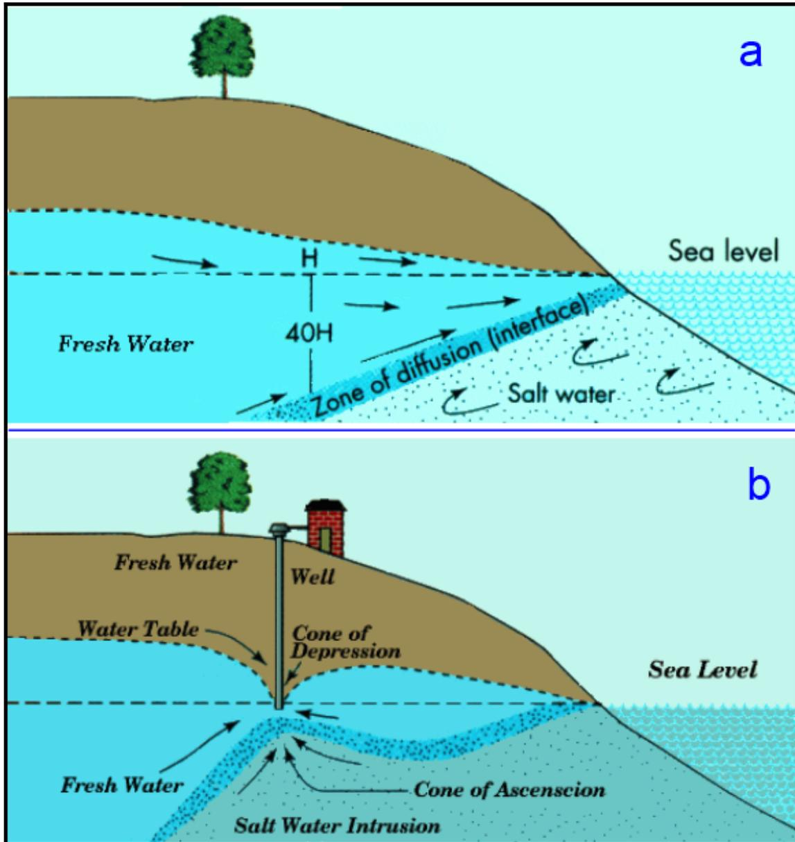
Figura Anexo 1.1. Nivel de agua salada y agua potable separados por una zona de transición (a). Alteración del comportamiento del agua dulce y salada debido a la perforación de pozo (b). Imagen tomada de Lenntech.
