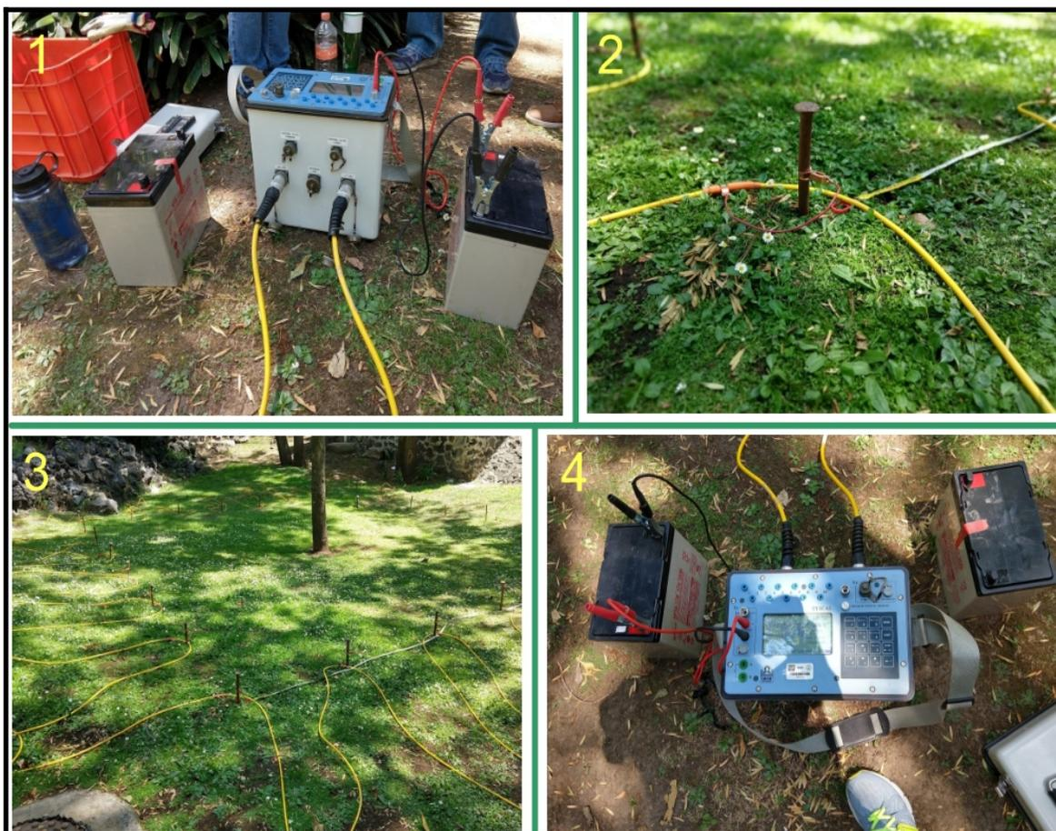
*Figura 4.1.2. Se muestra la consola conectada a la batería y a los cables (1); electrodo conectado al cable (2); ejemplo de un tendido (3); la consola vista desde la parte superior, conectada a la batería (4).*
