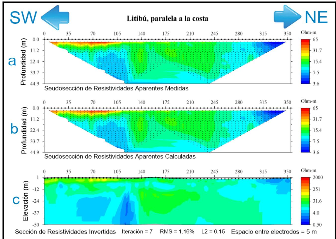
Fig 4.3.5. Resultado del perfil de Litibú, paralela a la línea de costa, usando inversión suave.
