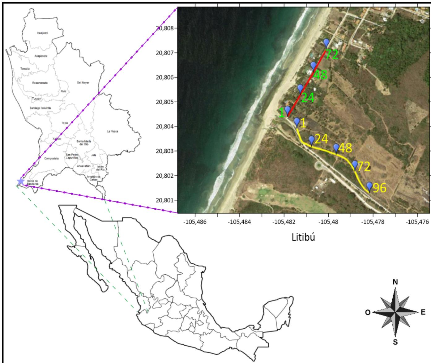
Fig 4.3.3. Distribución de los perfiles de resistividad eléctrica y la numeración de algunos electrodos en la zona de Litibú.
