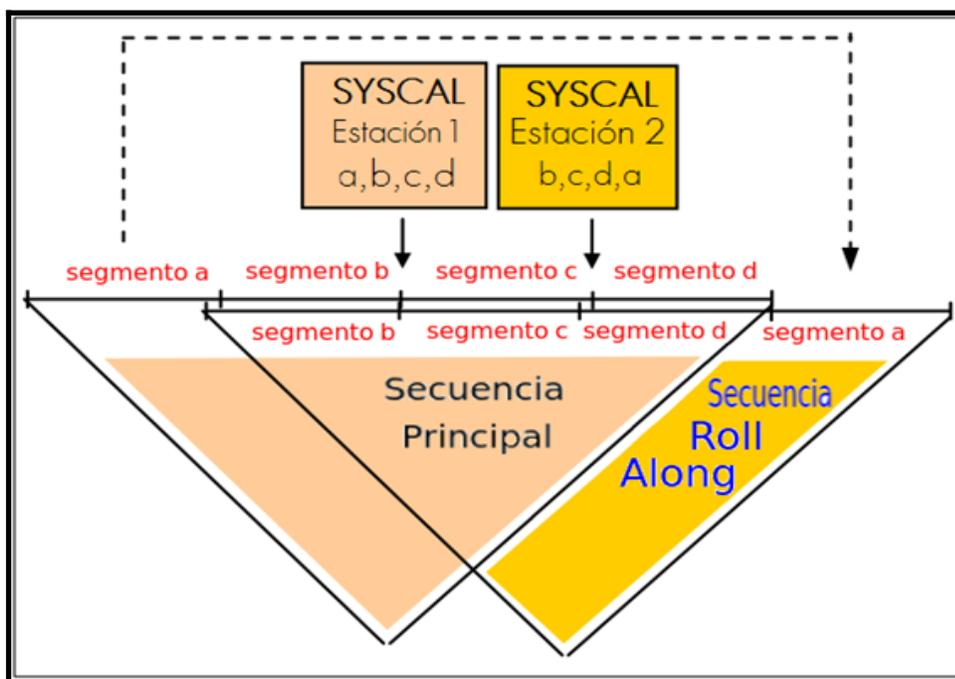
Figura 4.1.1. Esquema de la técnica roll- along. El segmento a, es el que se va a desplazar al final para continuar con la toma de datos, después se recorrerá el segmento b al final, así sucesivamente hasta que se terminen las mediciones (Imagen modificada, Iris Instruments).
