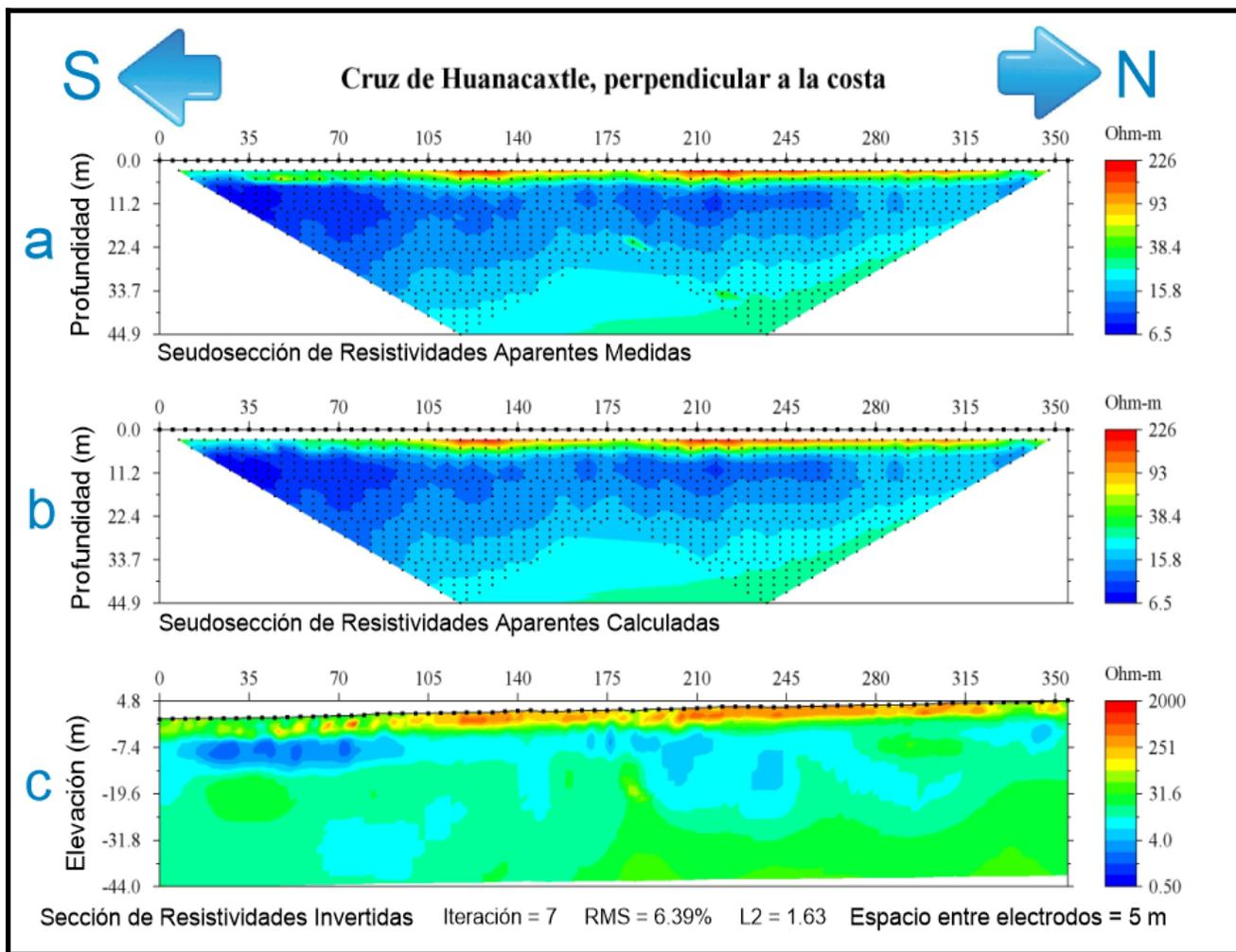
Fig 4.3.2. Resultado del perfil ubicado en Cruz de Huanacaxtle, perpendicular a la línea de costa, usando inversión suave.
