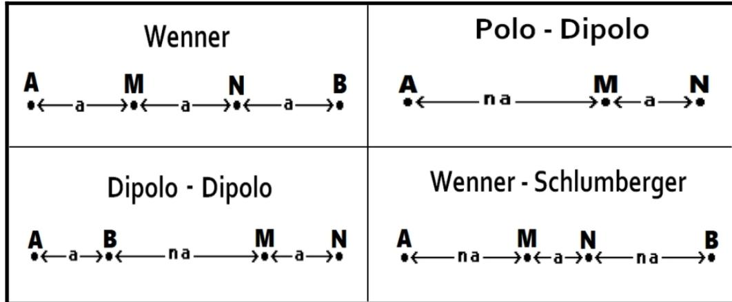
Figura 2.3.1. Configuraciones electródicas, distribución de los electrodos (modificado de Loke, 2000).
