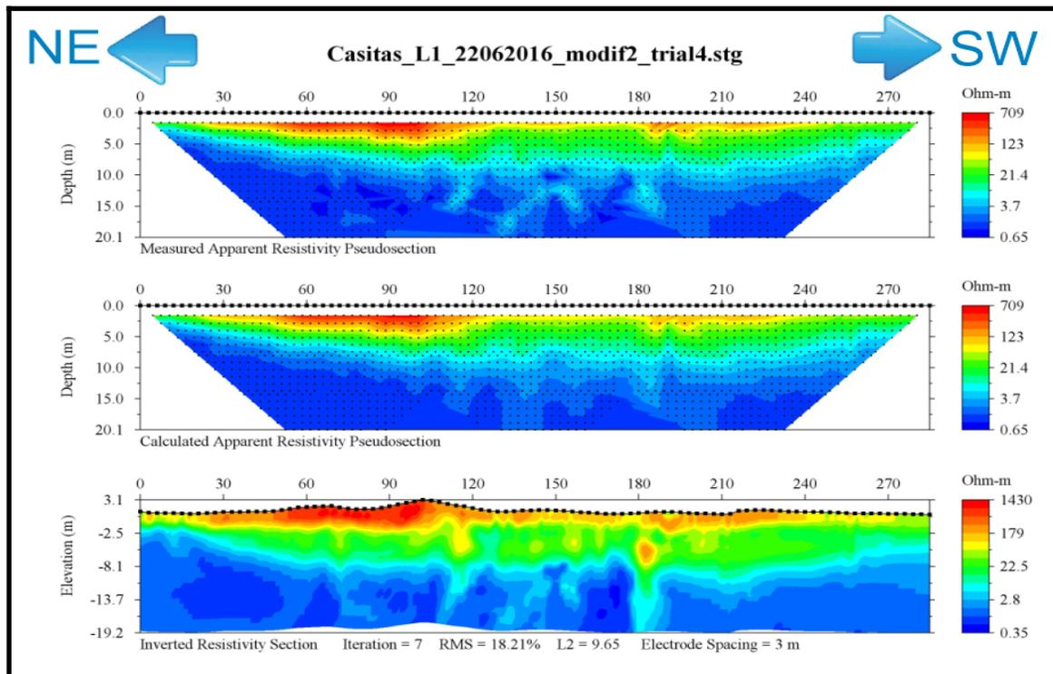
Figura Anexo 3.2. Sección original de Casitas perpendicular a la línea de costa, con inversión robusta, sin modificar la escala de resistividades.
