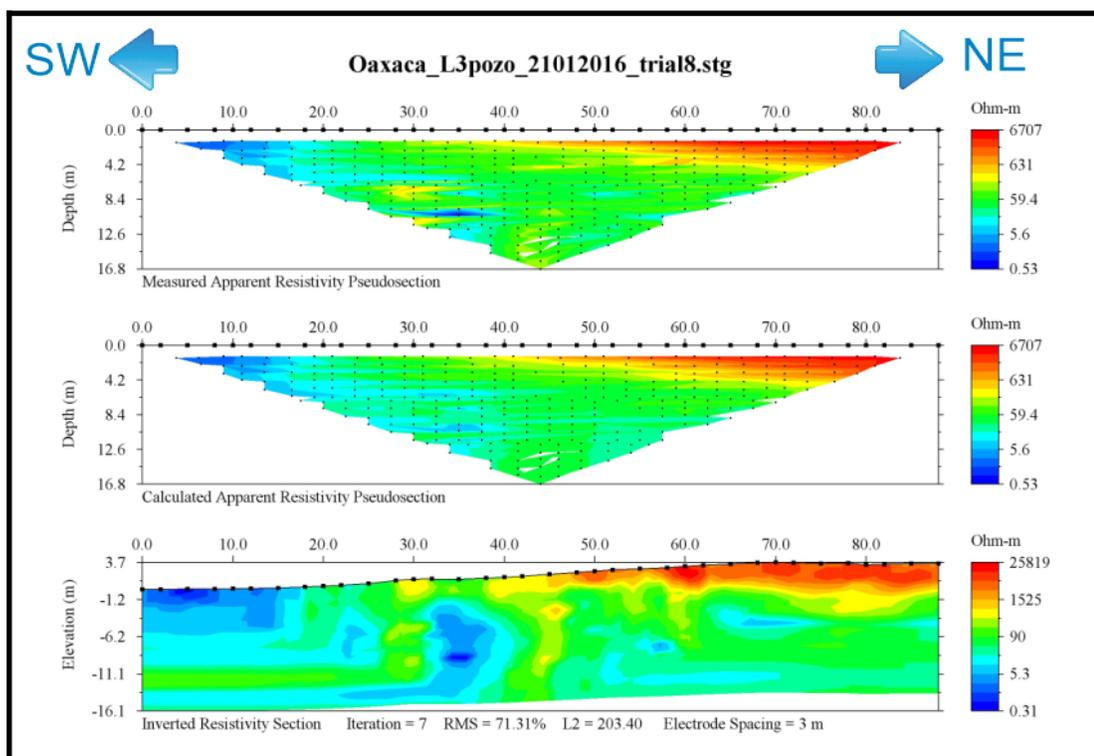
Figura Anexo 3.16. Sección sin filtro con máxima resistividad 30,000 [ohm•m] del perfil cercano al pozo en Oaxaca.
