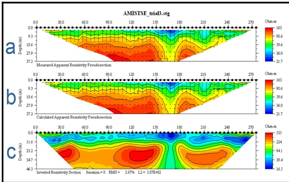
Figura 4.1.6. Ejemplo de la imagen que despliega EarthImager 2D al finalizar la inversión (Tomada de AGI).
