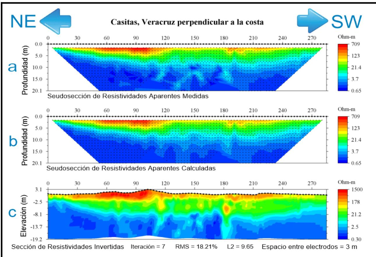
Figura 4.2.2. Resultado del perfil perpendicular a la línea de costa en el sitio de Casitas empleando inversión robusta.
