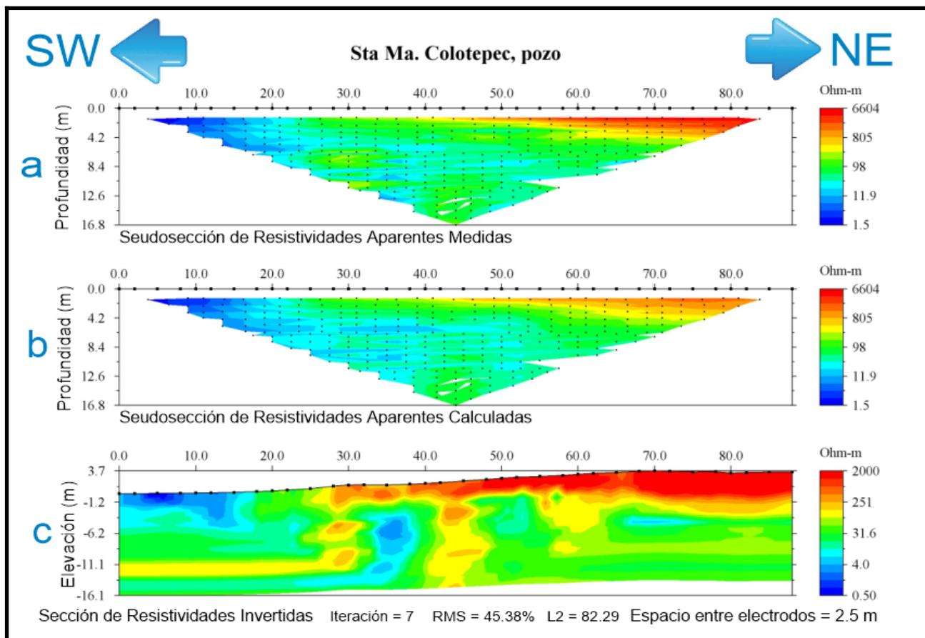
Fig 4.4.3. Resultado del perfil cercano al pozo, utilizando el filtro media móvil y una inversión robusta.
