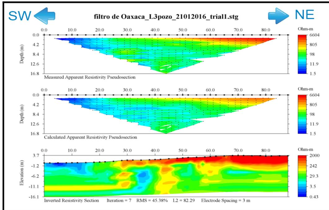
Figura Anexo 3.14. Sección original aplicando filtro, sin cambiar escala de resistividades, de la zona cercana al pozo en Oaxaca.
