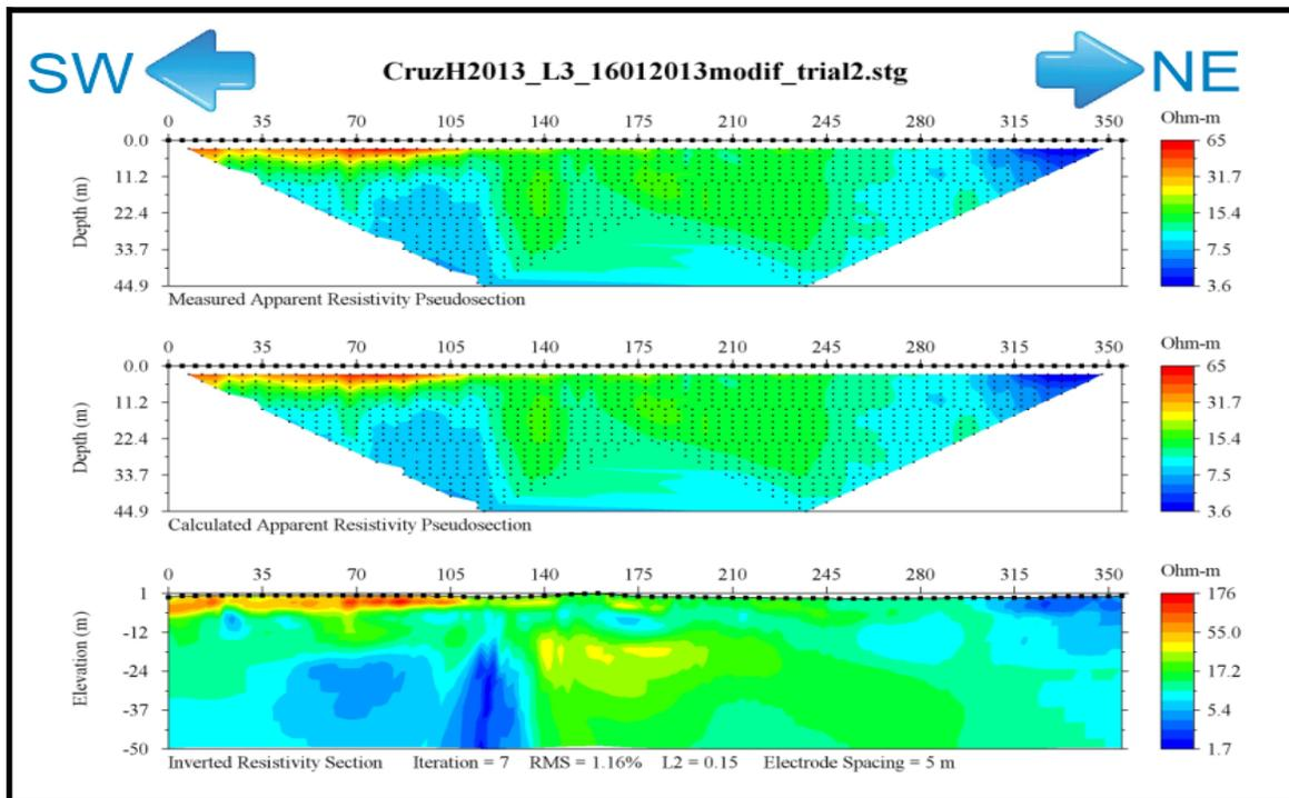
Figura Anexo 3.10. Sección original, sin cambiar escala de resistividades del perfil paralelo a la línea de costa en Litibú, utilizando una inversión suave.
