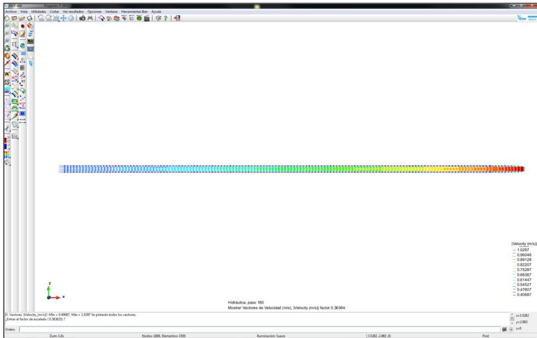
Figura 4.29a. Visualización de la velocidad presentada por medio de vectores y un espectro de colores en el modelo del perfil N° 1.
