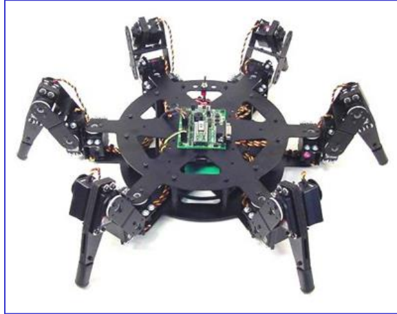
Ilustración 58. Hexápodo de base circular 'Kit de robot hexápodo Lynxmotion BH3-R'. (Consultada Julio 2019) Ilustración obtenida del sitio web: https://www.robotshop.com/en/lynxmotion-bh3-r-hexapod-robot-kit-bh3rcau-blk.html
