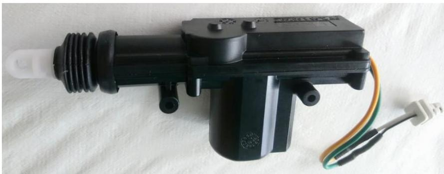
Figura 2.9 Actuador eléctrico
