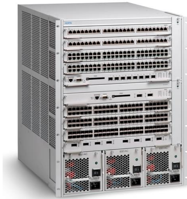
Figura 11. Equipo PBX [11] con puertos de extensiones TDM [10]
