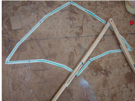
Figura 76 Contorno del espacio de trabajo del prototipo del mecanismo
