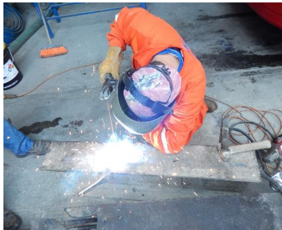
Aplicación del segundo cordón de unión
