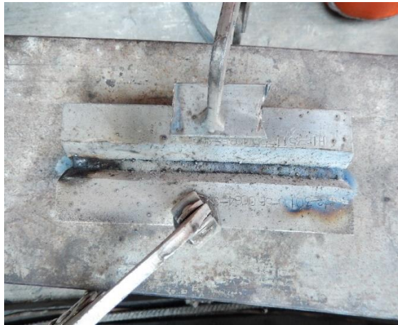
Paso en caliente antes de retirar la escoria
