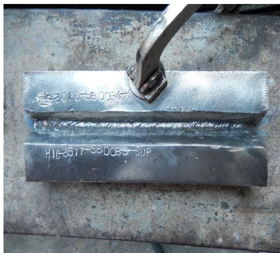
Barra pulida después de aplicar el 2º Cordón
