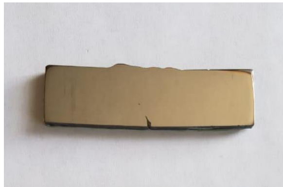
Figura 4.13. Probeta pulida utilizada para realizar los ensayos propuestos para analizar la ZAC.
