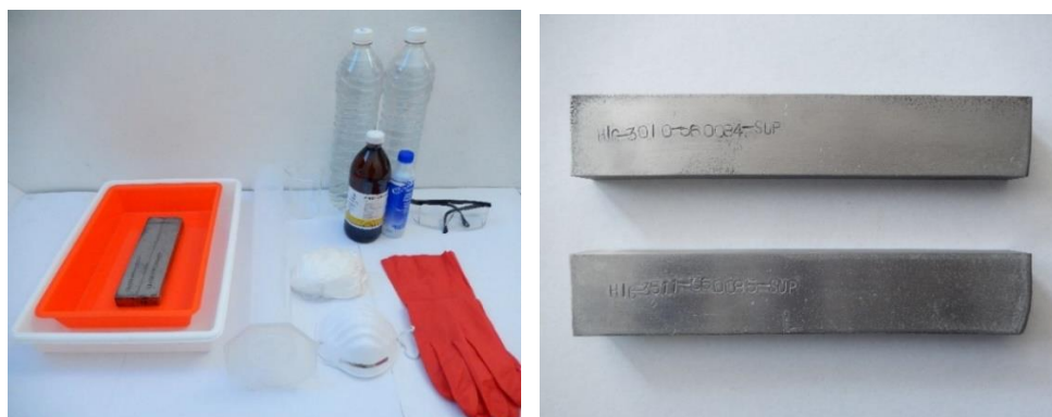
Figura 4.4. Decapado de las placas de acuerdo a la norma ASTM G1-03 (2017).
