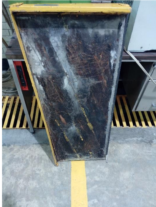
Figura 16. Madera dañada por humedad
