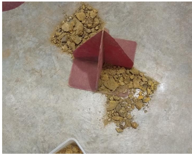
Figura 11.1. Separación de cuartos para tener una muestra representativa
