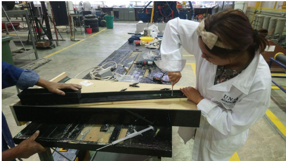
Figura 17.3 Construcción de mesa concentradora
