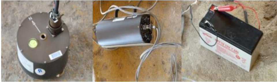
Figura 2.16. Equipo de instrumentación (acelerómetro triaxial, digitalizador, batería de 12V respectivamente)
