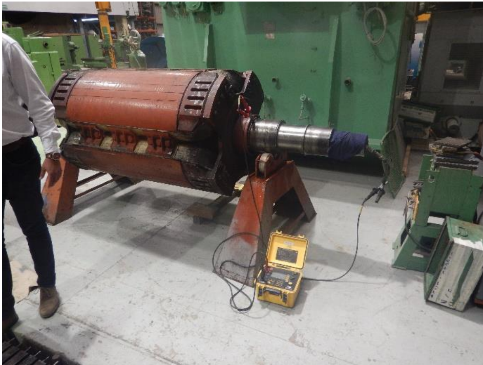
Figura 3.1 Pruebas al rotor del generador, en laboratorio.
