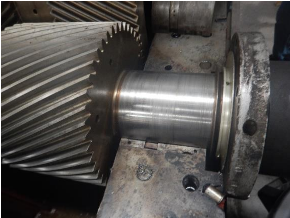
Figura 3.25 Rodamientos de reductor dañados.
