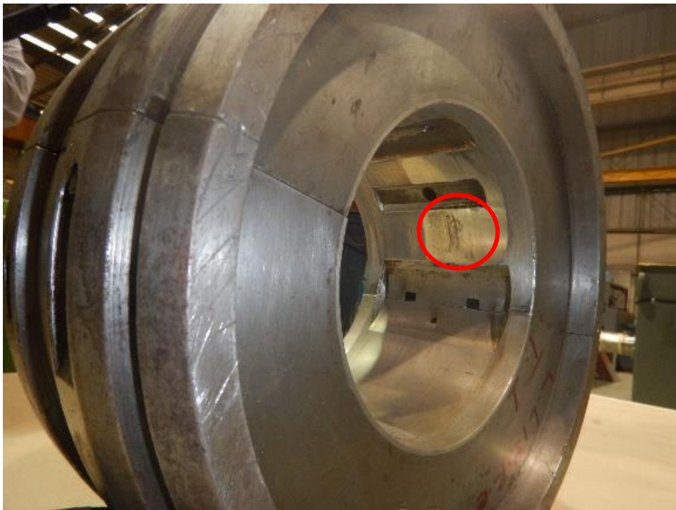
Figura 3.27 Chumacera dañada con afectaciones internas.
