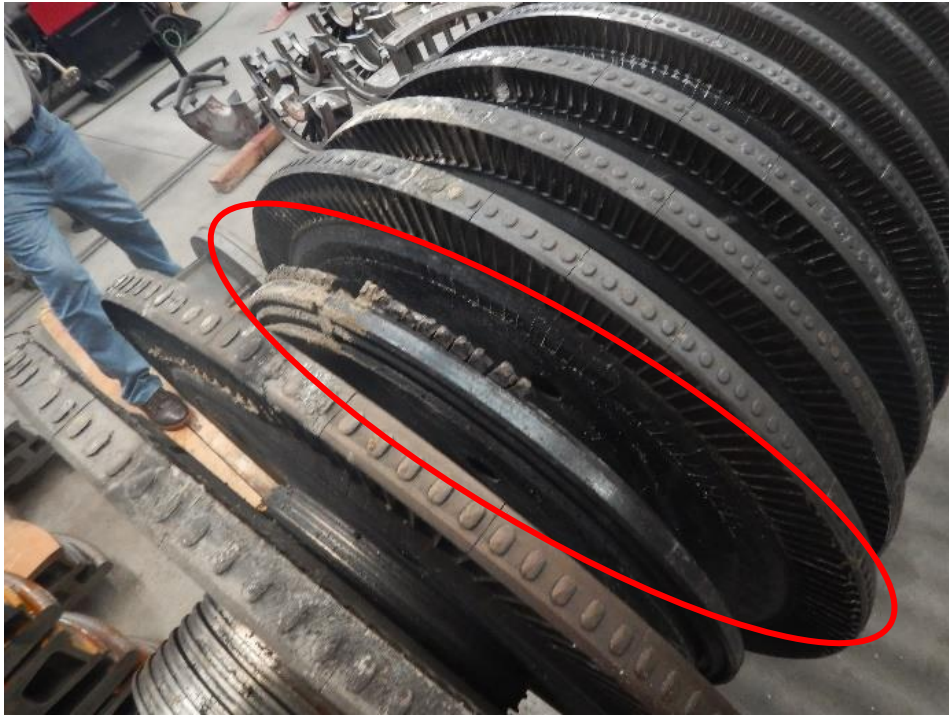
Figura 3.2 Disco número 10, afectado y con los alabes totalmente destruidos.
