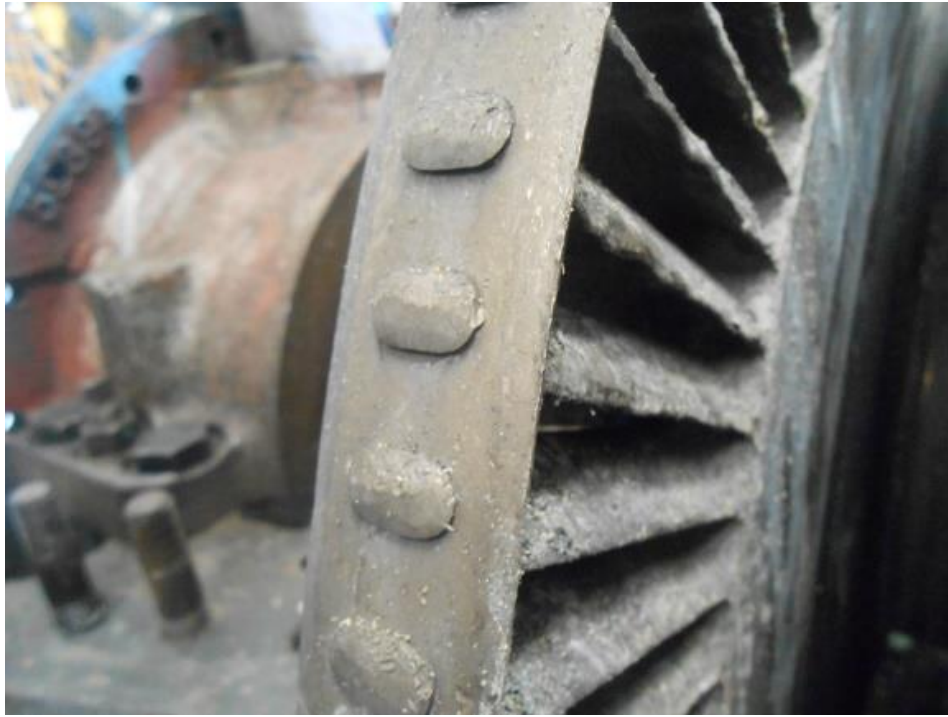
Figura 3.13 Residuos de material en álabes.
