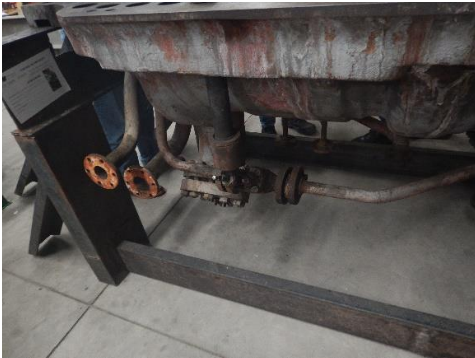
Figura 3.33 Sistema de extracción de la turbina
