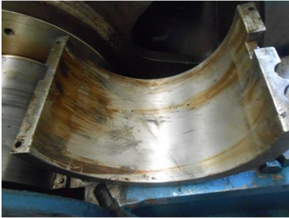
Figura 3.26 Rayaduras en asiento de rodamiento.
