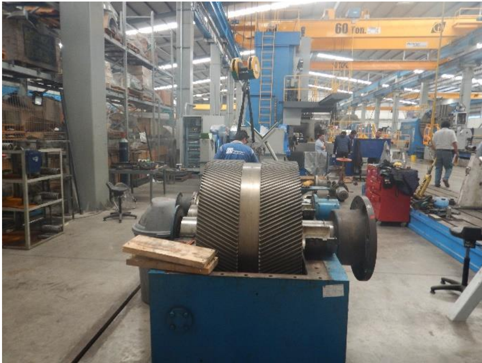
Figura 3.3 Reductor de velocidad siendo desarmado con cubierta superior retirada.
