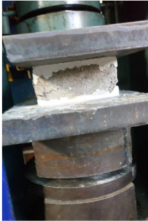
Figura 34. Resistencia a la compresión
