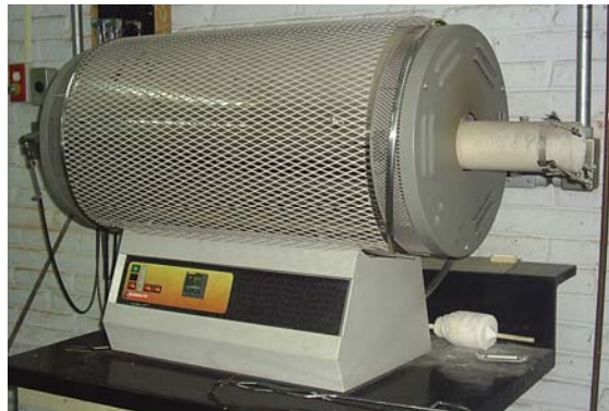
Fig. 3.8 Horno de tubo para proceso de homogeneizado
