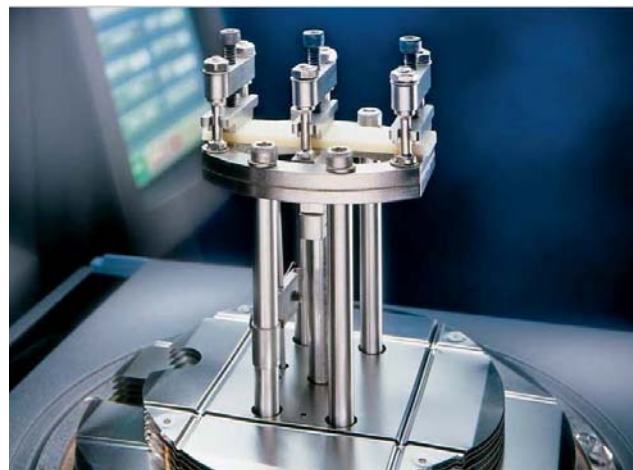
Fig. 5.8 Arreglo de las pinzas para una prueba en cantiliver doble. Para cantiliver simple únicamente la probeta se hace mas corta y se empotra de un sólo lado.
