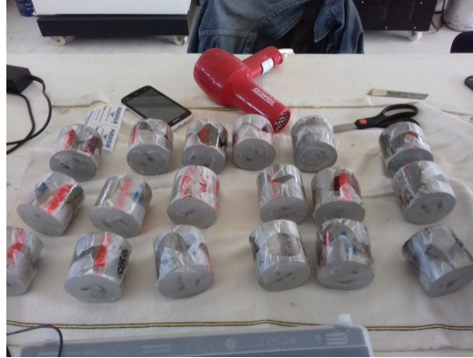
Figura 4.5: Papel encerado en las probetas de cemento.
