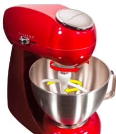
Figura 4.1: Mezcladora usada para la elaboración de pastas de cemento.
