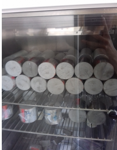
Figura 4.4: Probetas en cámara con temperatura y humedad controlada.
