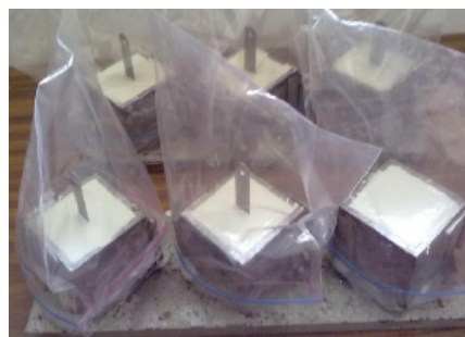
Figura 4.3: Probetas con calibreadores de bujías de distintos grosores.
