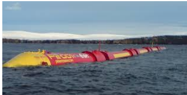
Fig. 7 Sistema de captación Pelamis. (obtenida [15]).
