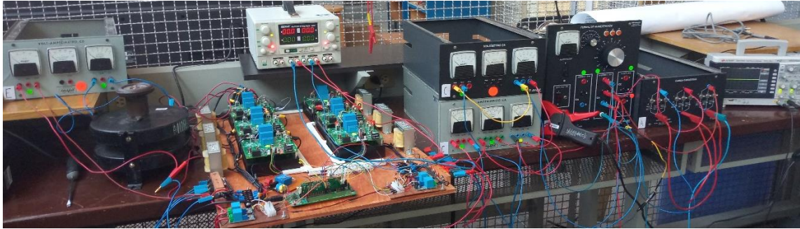
Fig. 57 Prueba como inversor.
