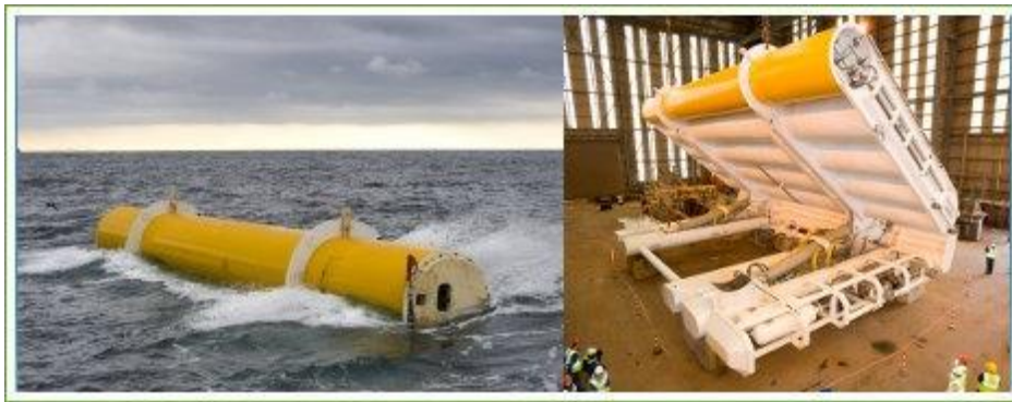
Fig. 9 Sistema de generación oyster. (Obtenida [18]).
