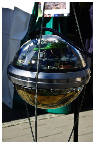
Figura 2.9: Fotomultiplicador utilizado en IceCube.
