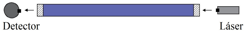
Figura 5.10: Sistema para medir la longitud de transmisión de una muestra de agua
