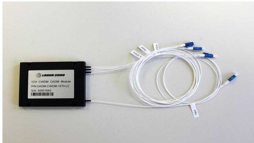
Figura 32. Representación de un multiplexor óptico.
