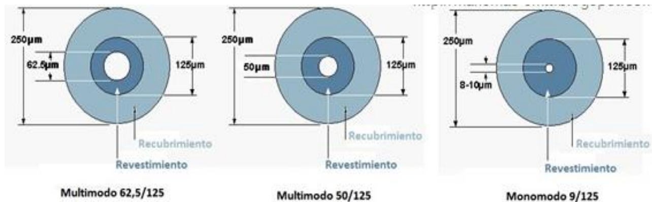
Figura 2. Medidas de los núcleos de las fibras SMF y MMF.
