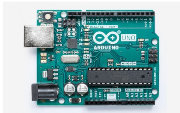
(b) Placa de desarrollo Arduino UNO con el microcontrolador ATmega328P incorporado
