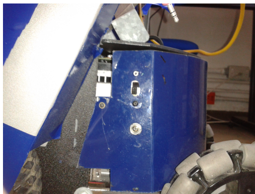
Figura 4.3: Interruptor de la computadora principal.
