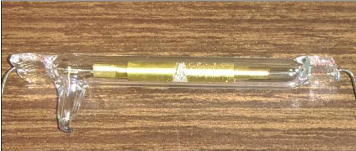
**Figura 47: Memristor de tipo Marconi en posición horizontal.**
