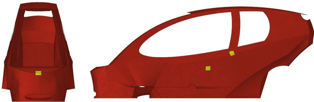
Figura 4.12 A la izquierda, vista frontal, en amarillo el área de colocación de la fuerza para el FWFI. A la derecha, vista lateral con las áreas de colocación de fuerza para el SBI y OPSI en amarillo.
