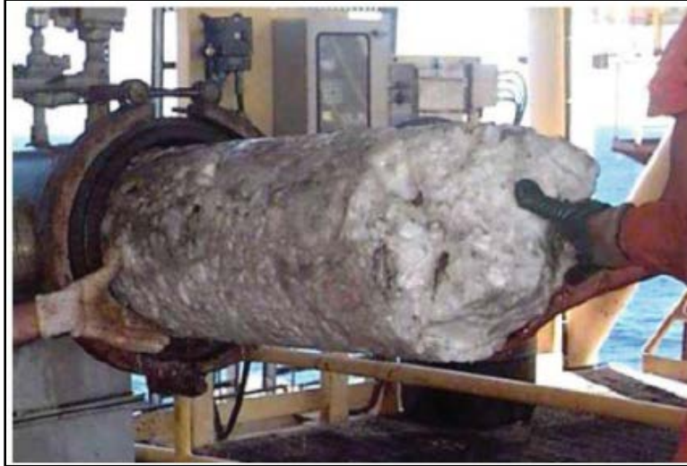
Figura 2.3 Formación de un tapón de hidrato en tubería. (Beacon, 2016).
