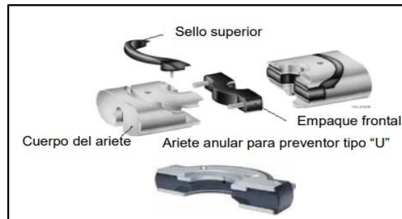
Figura. 1.11 Ariete anular para preventor tipo "U". (Estandarización de conexiones superficiales de control., 2003).
