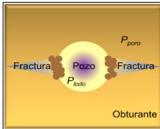
Figura. 2.37 Uso de material obturante para controlar pérdidas. (PEMEX, Guía práctica para el control de pérdidas de circulación, 2008)
