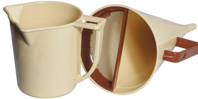
Figura 325. Prueba de viscosidad Marsh.
