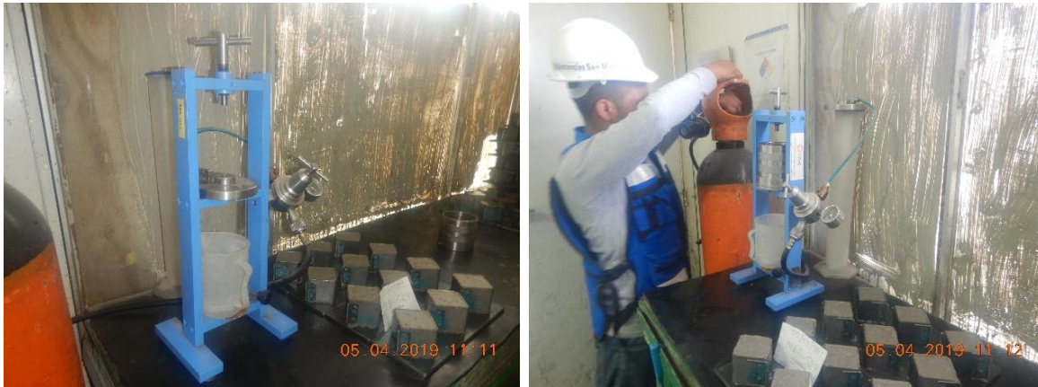
Figura 322. Prueba de filtrado.
