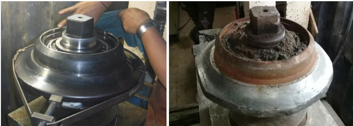
Figura 213. Ingreso de material fino al interior del disco cortador.
