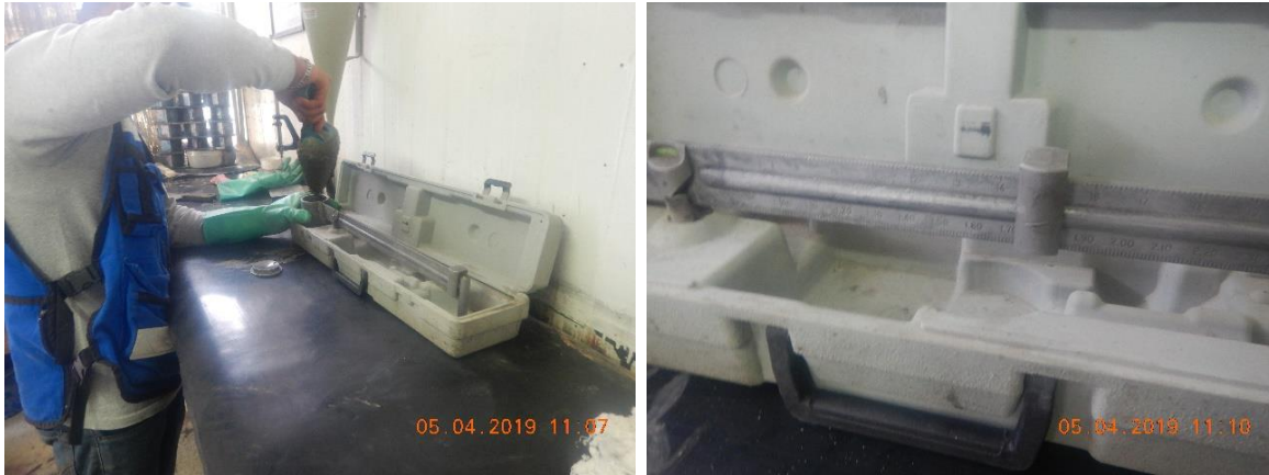
Figura 321. Obtención de la densidad del mortero.
