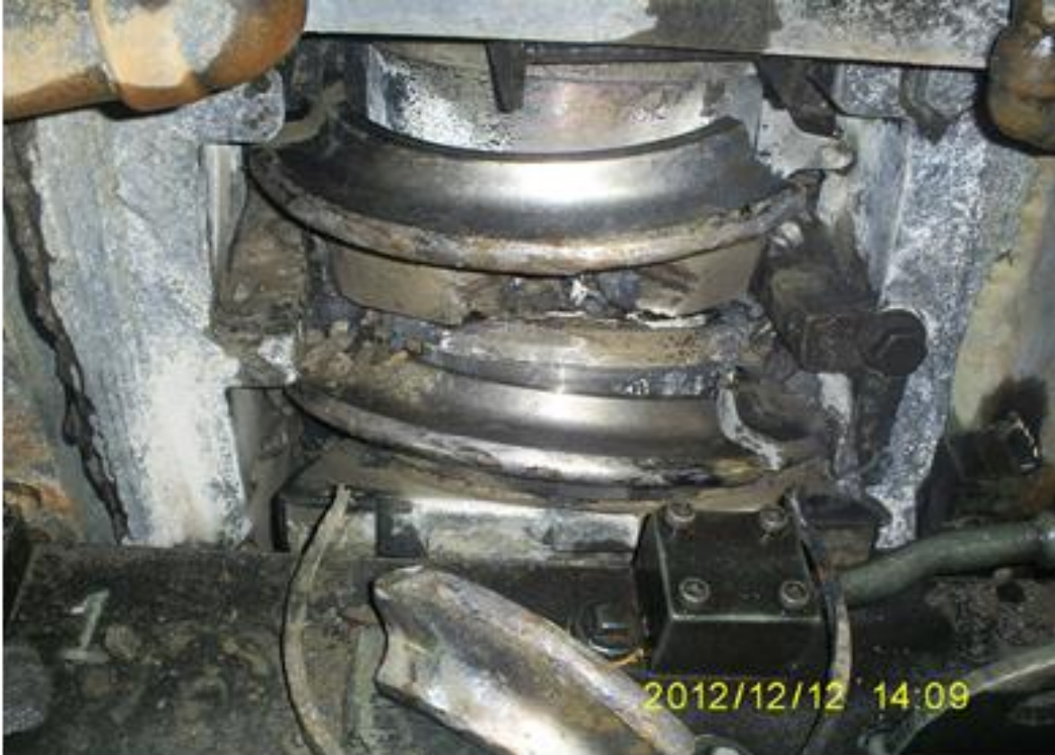
Figura 263. Daño presentado en un cortador central.
