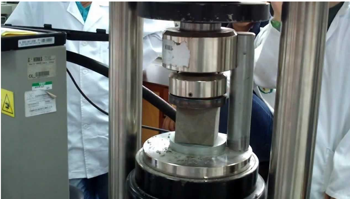
Figura 324. Prueba de compresión del mortero.
