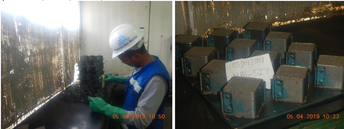
Figura 323. Muestras de mortero realizadas para la prueba de compresión.
