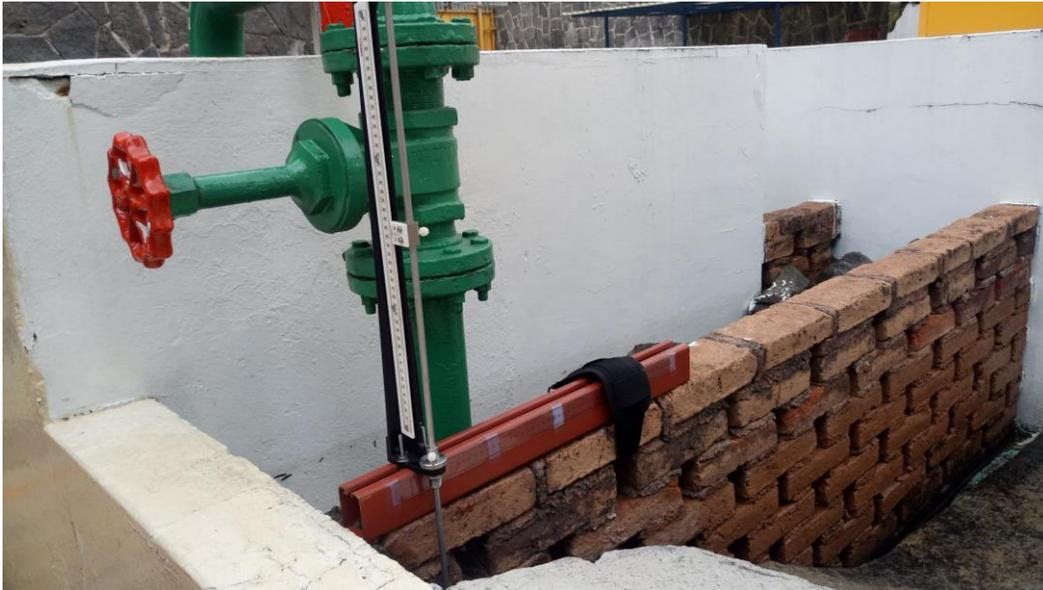
Figura 3.11 “Limnómetro de punta”
