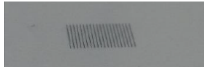
Figura 5.1.4. Máscara de estructura periódica sobre acetato
