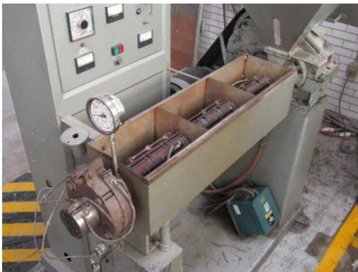
Ilustración 6. Vista de la camisa de la extrusora, donde se puede ver las resistencias de tipo banda
