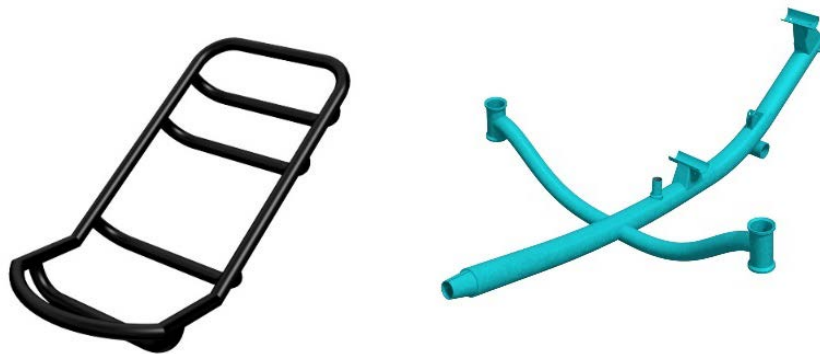
Figura 3.27- Avance de las geometrías asiento y cuadro (modelado 3D)
