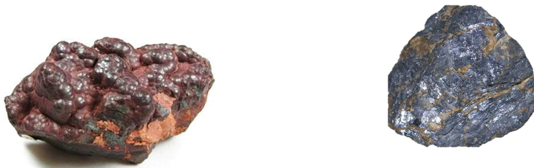
Figura 6.4.1. Mineral Hematita, \text{Fe}_2\text{O}_3 (metal ferroso) mena de hierro y mineral Galena, \text{PbS} (metal no ferroso), mena del plomo. (2005). Minerals. [Figura]. Recuperado de: https://geology.com/minerals
