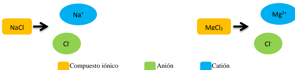
Figura 2.1. Disociación electrolítica del compuesto iónico de cloruro de sodio (NaCl) y cloruro de magnesio (MgCl 2 ) en sus respectivos iones.
