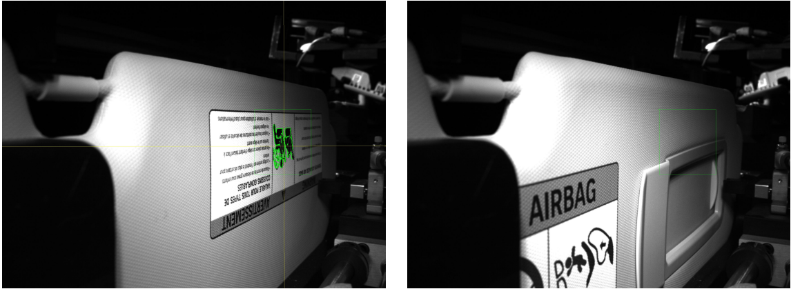
Figura 5.9. Herramienta etiqueta Norte Americana Pasado/Fallado respectivamente con cámara Front
