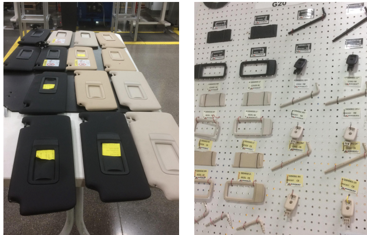
Figura 4.3. Modelos de prueba y piezas que forman una visera
