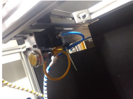
Figura 5.11. Pistón y sensor para la función de detección de parte extrusión en viseras tipo SOR
