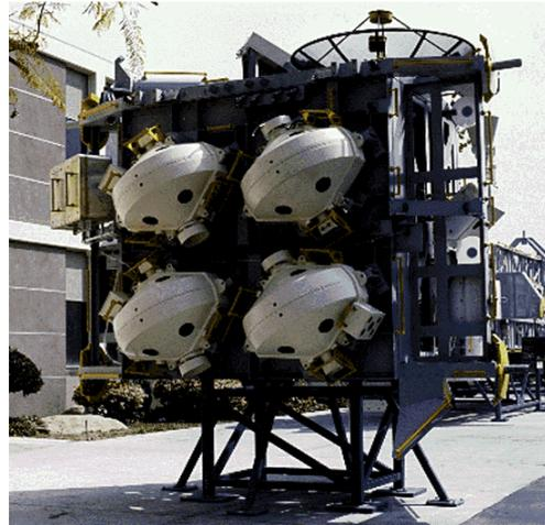
Figura 1.20 Ejemplo de giroscopio de control de momentos<sup>28</sup>
