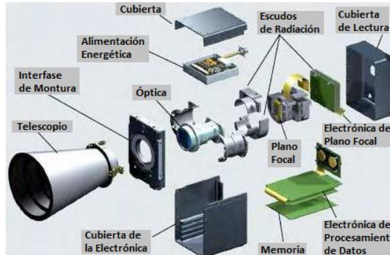
Figura 1.17 Esquema de un sensor de estrellas
