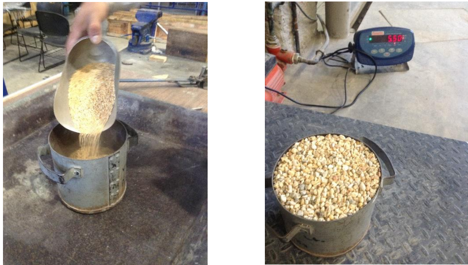
Fig. 9 Espacios vacíos sin compactar.
