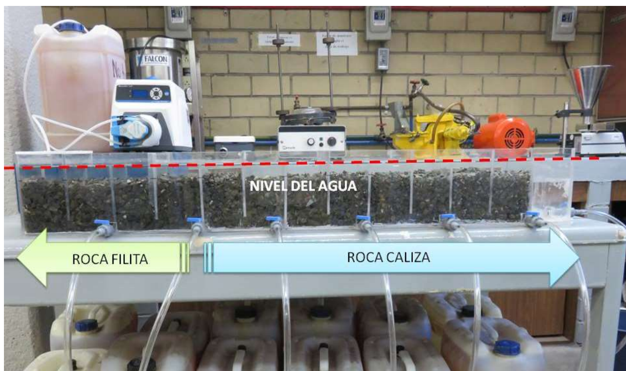
Figura 4-3. Preparación de la celda
