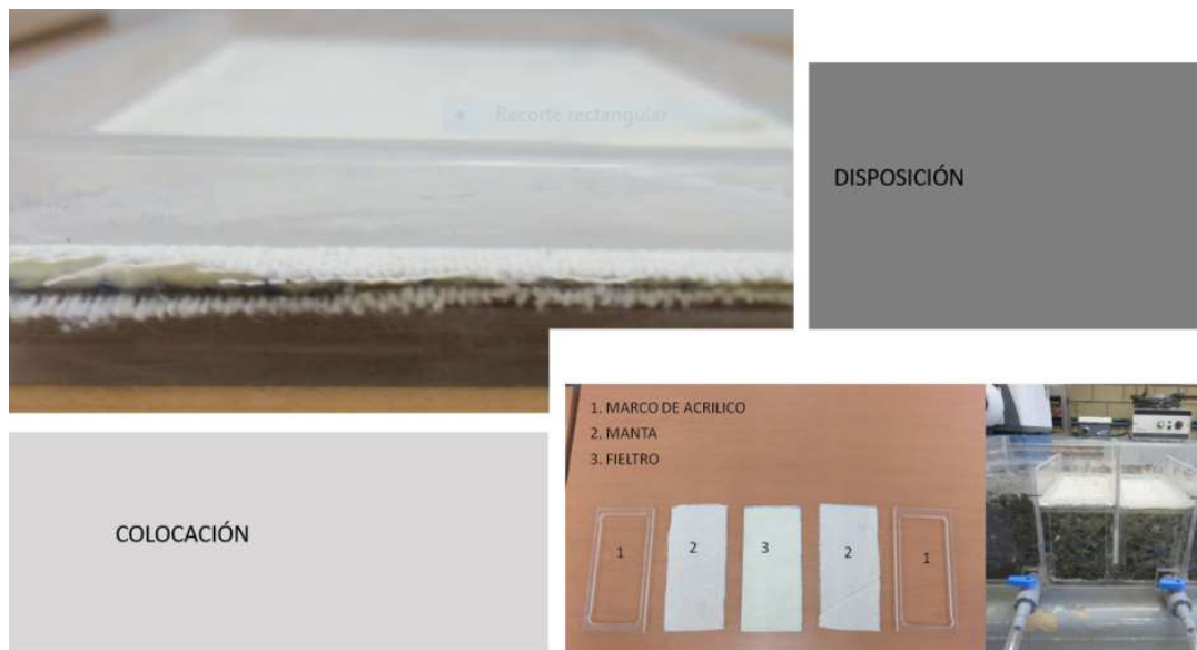
Figura 4-2. Disposición y colocación del filtro
