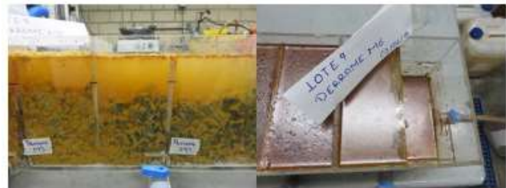
Figura 6-13. Obstrucción del flujo a causa de la acumulación de sedimentos
