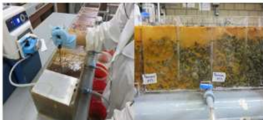
Figura 6-11 Agitación y acumulación de sedimentos en lote 7
