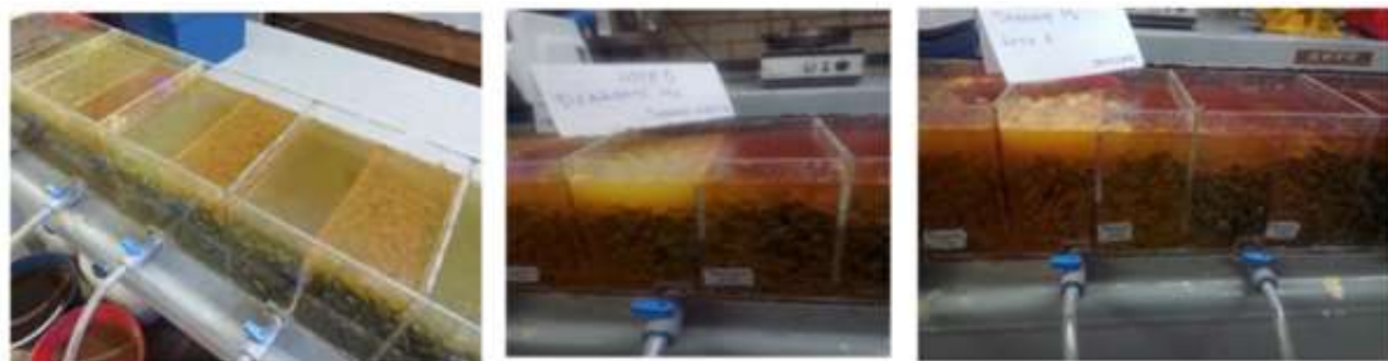
Figura 6-10 Acumulación de precipitados durante la neutralización de los lotes 4, 5 y 6
