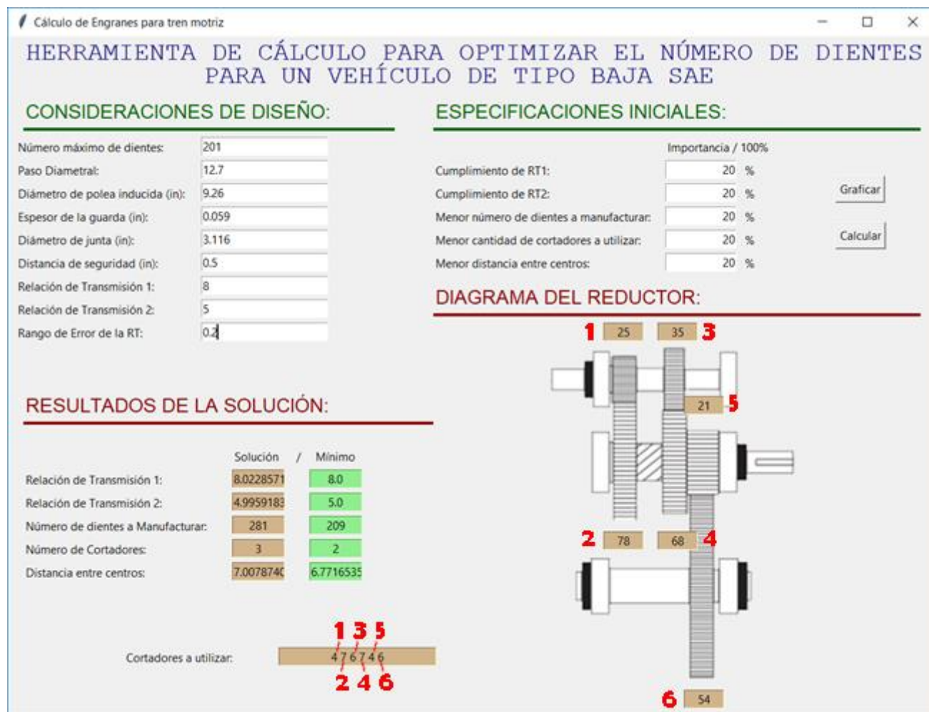
Figura 6.1. Resultado de tren motriz de máximo 200 dientes, con misma importancia en parámetros.
