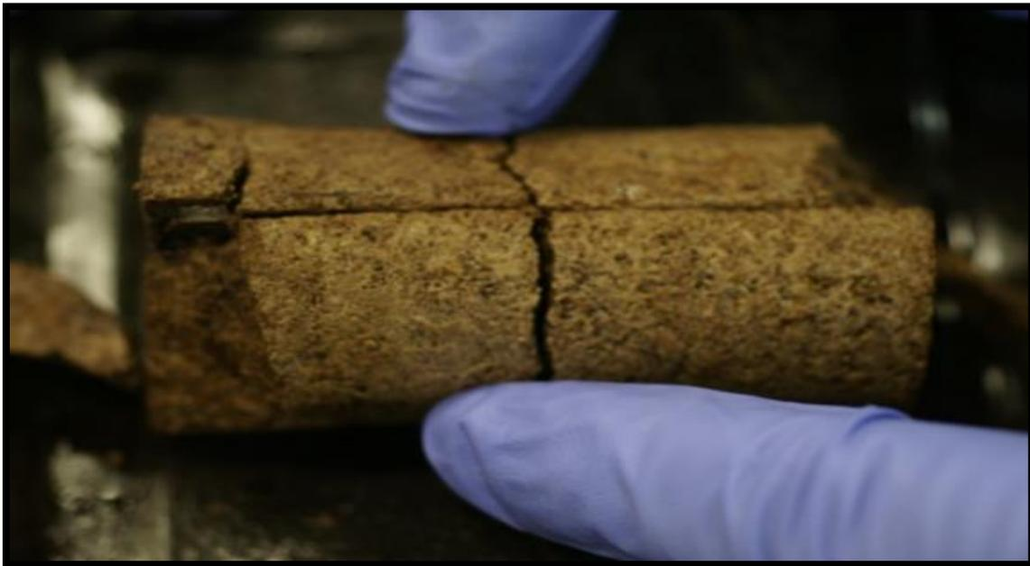
**Figura 41.** Estructura del núcleo después del confinamiento.
