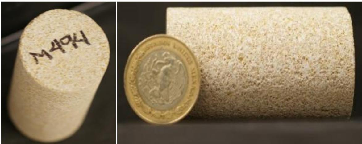
**Figura 11.** Núcleo utilizado para las pruebas de desplazamiento.
