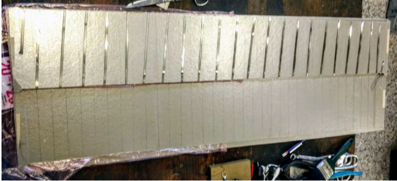
Figura 3.3: Tejido cinta de Nicrom en mica aislante.
