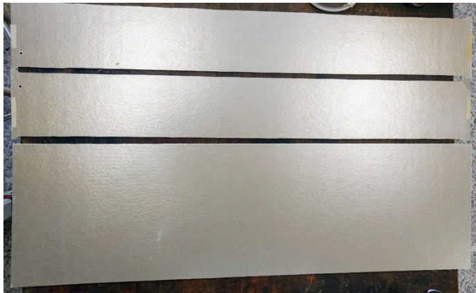
Figura 3.2: Cortes en la mica aislante.
