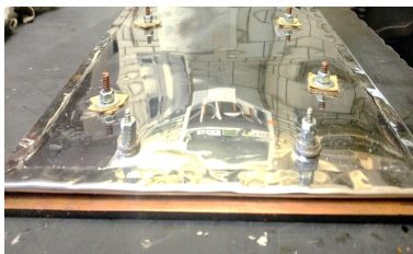
(a) Placa de cobre y resistencia eléctrica
