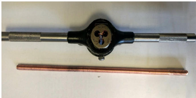
Figura 3.12: Machuelo y barra de cobre.
