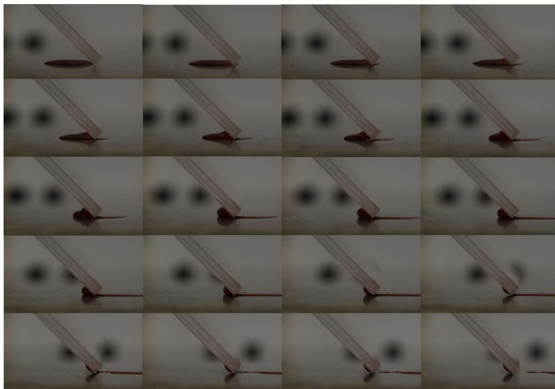
Figura 4.10: Secuencia temporal del experimento de barrido. Conforme la espátula cambia de posición y entra en contacto con la gota de encáustica, esta se deforma para adquirir la altura de la espátula. Es importante identificar que parte de la masa de la gota queda adherida a la espátula.
