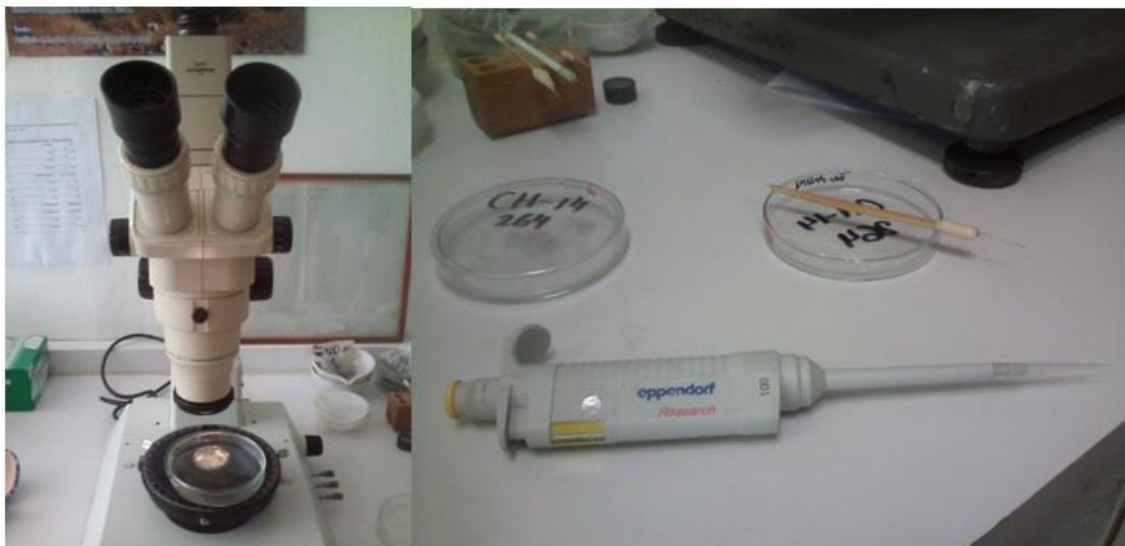
Fig. 3. 7 Materiales empleados para la separación manual de circones detríticos del Laboratorio Universitario de Geoquímica Isotópica.
