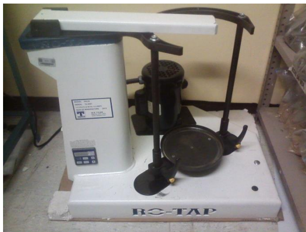
Fig. 3. 2 Rotap Tyler RX-29 del Laboratorio de Geoquímica del Instituto de Ciencias del Mar y Limnología.
