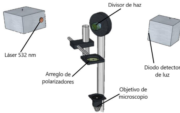
Fig. 3.4: Subsistema óptico. Extracto del sistema completo de escritura directa láser para fabricación de guías de onda.
