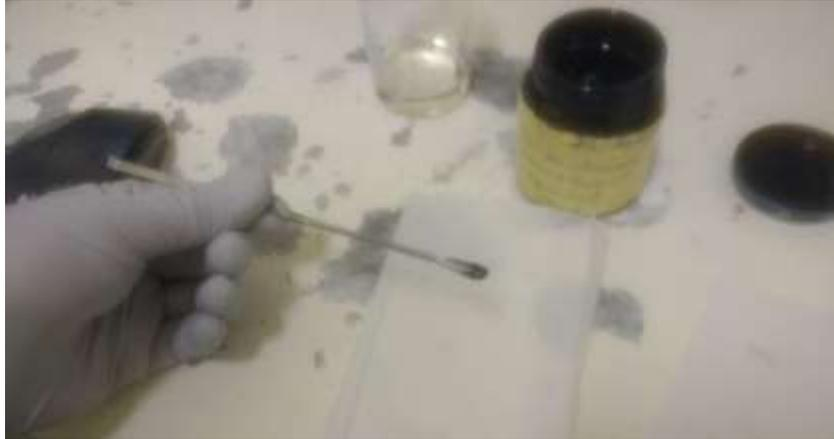
*Figura 11.- Toma de muestra de hidrocarburo*
