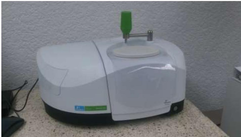
*Figura 6.- (Fotografía) Equipo FT-IR SPECTROMETER SPECTRUM TWO*
